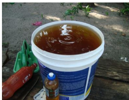
Figura 8 – Água avermelhada coletada de poço artesiano através de bomba manual
