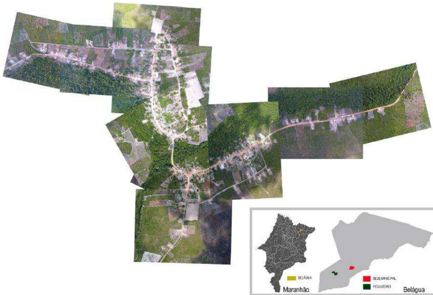
Figura 4 – Mapa de Pequizeiro construído com auxílio de VANT
