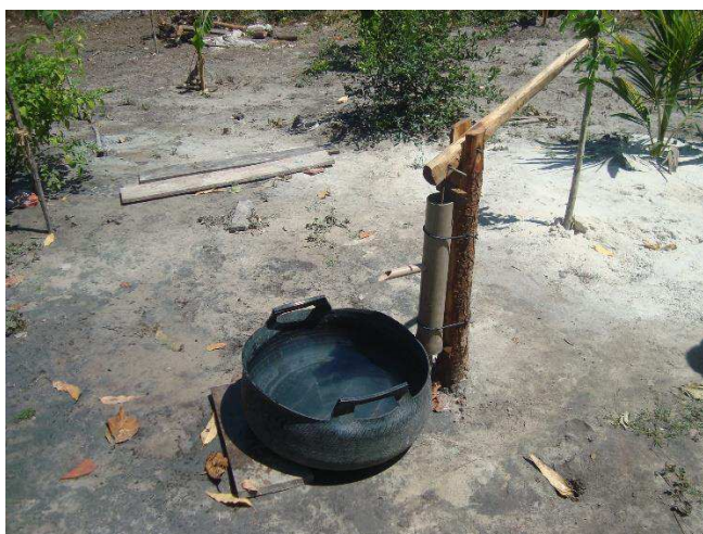
Figura 9 – Bomba manual de poço artesiano local
