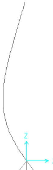
Figura 16: Deformada da parede devido à pressão hidrostática
