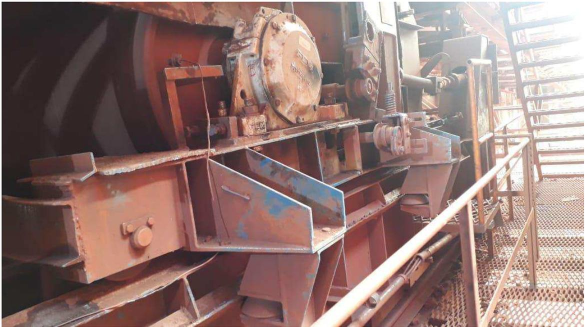
Figura 4.1 - Análise de campo da falha no tensionamento da correia do TRCO-10. (Autor)
