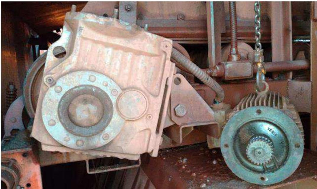
Figura 4.3 – Análise de campo da falha do redutor do alimentador da amostragem 3. (Autor)
