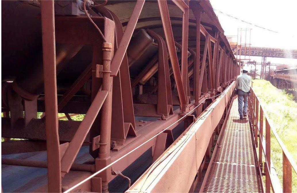
Figura 3.8 - Inspeção mecânica sensitiva no transportador de correia. (Autor)
