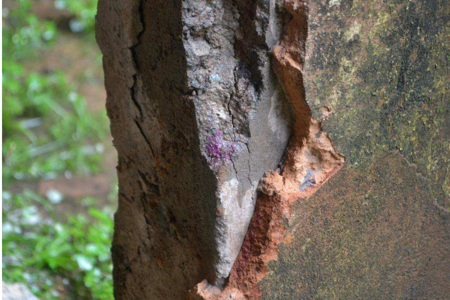
Fotografia 18 – Enfatização da carbonatação – toda parte cinza
