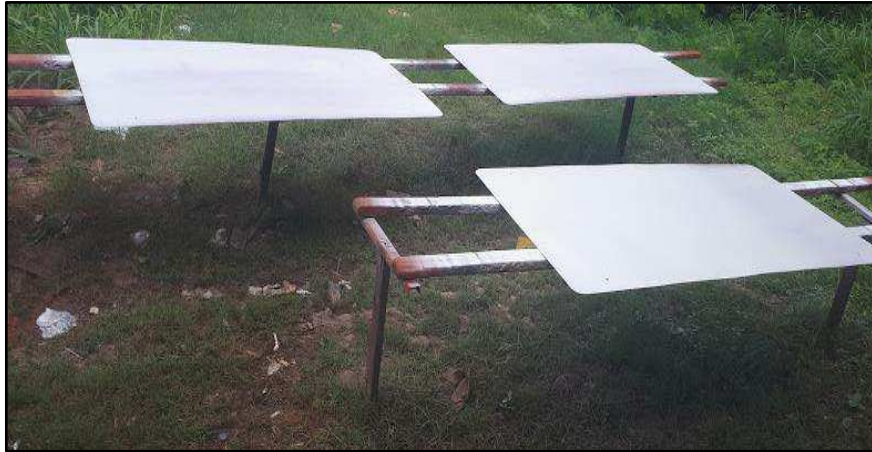
Figura 85 - Cura da tinta nitrocelulose nas chapas
