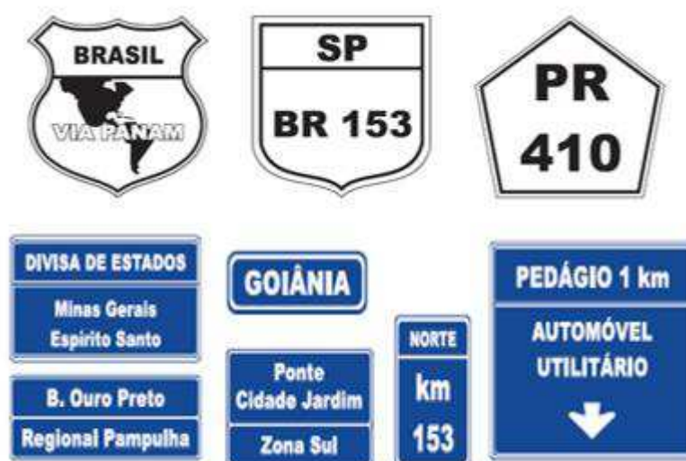
Figura 27 - Exemplos de Placas de Identificação
