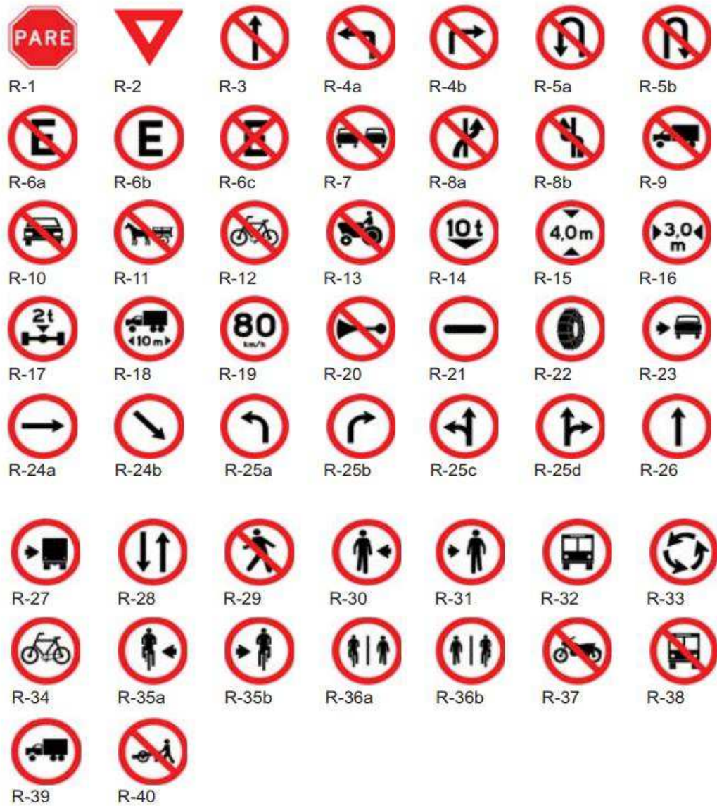
Figura 1- Conjunto dos Sinais de Regulamentação
