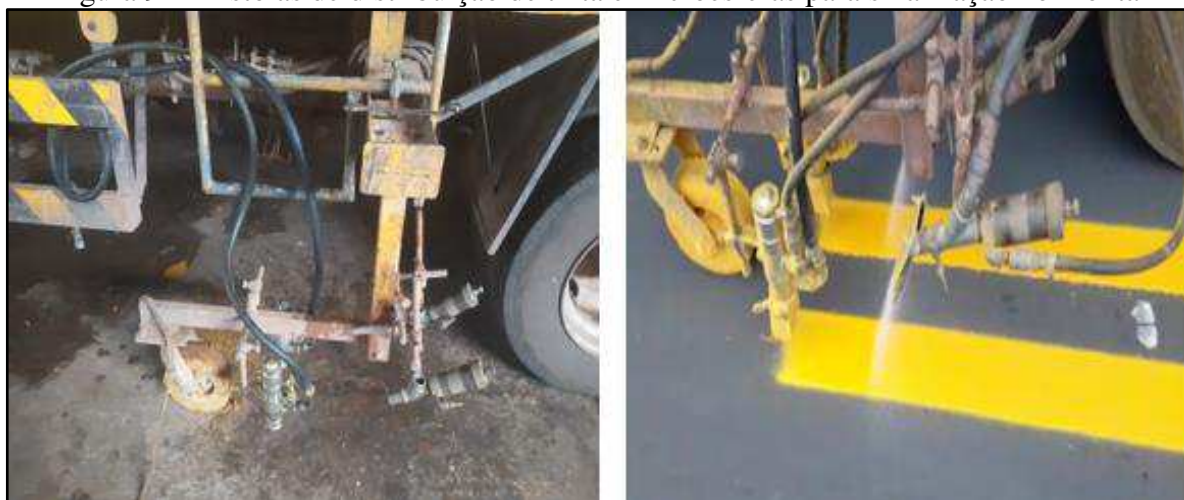
Figura 91 - Pistolas de distribuição de tinta e microesferas para sinalização horizontal
