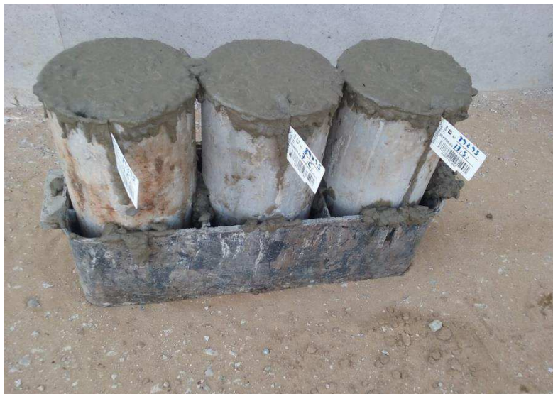
Figura 46 - Corpos de prova para ensaio de resistência
