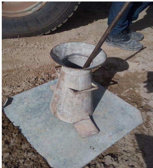
Figura 44 - Ensaio do Slump test
