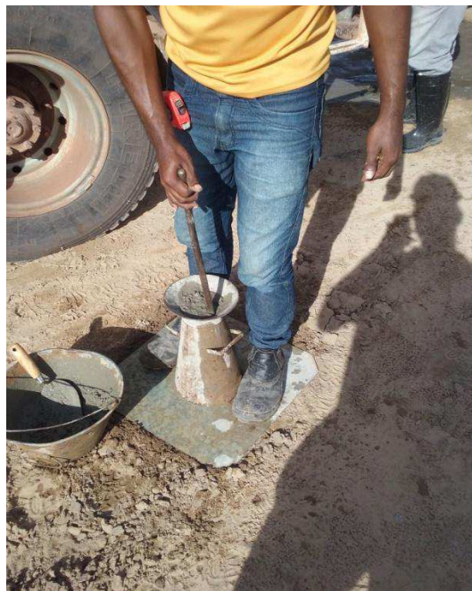
Figura 44 - Ensaio do Slump test
