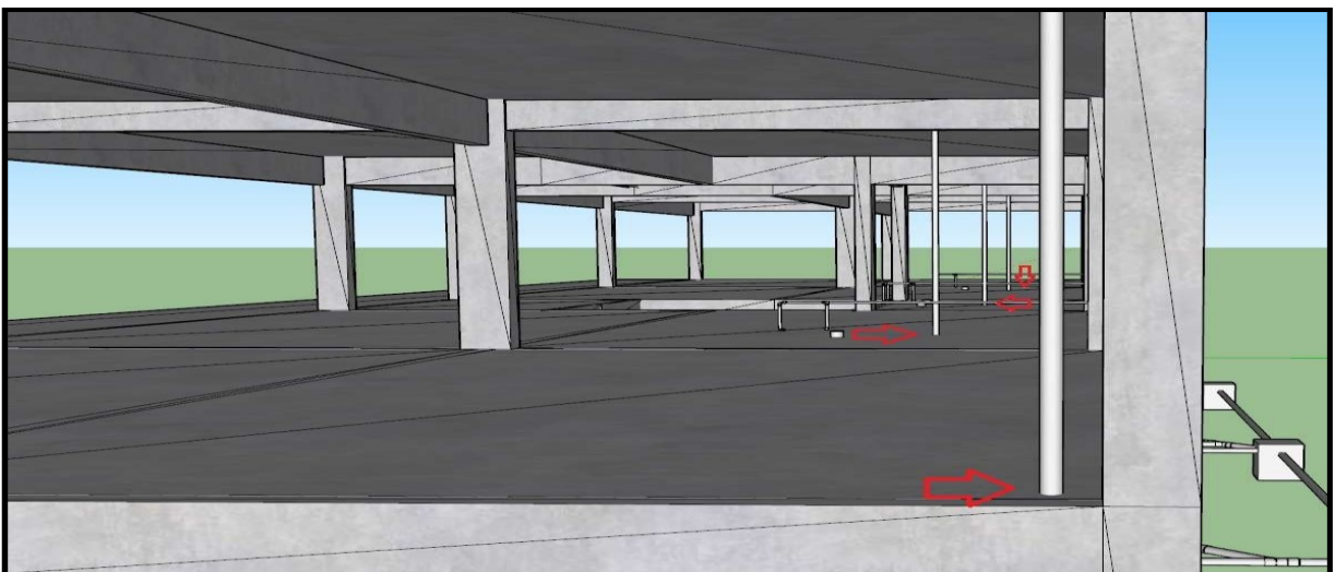
Figura 27 – Tubos atravessando lajes
