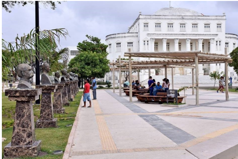
Figura 44 – Complexo Deodoro reformado com piso tátil Fonte: O Imparcial Acesso em 19 de Novembro de 2019.
