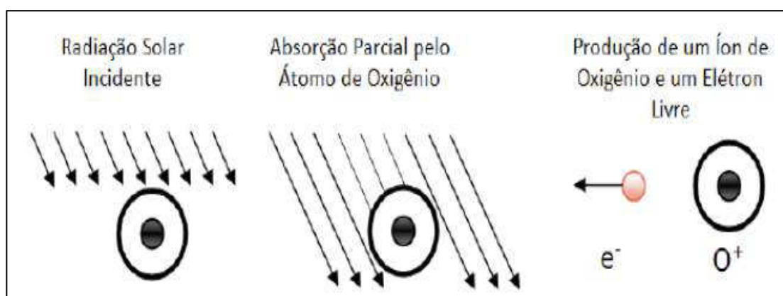
FIGURA 3.2 – Processo de fotoionização (POZ, 2010).
