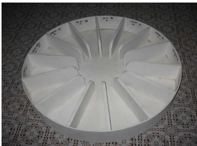
Figura 1. Modelo de arena circular utilizado no teste de preferência alimentar de Sitophilus sp. com variedades de arroz.
