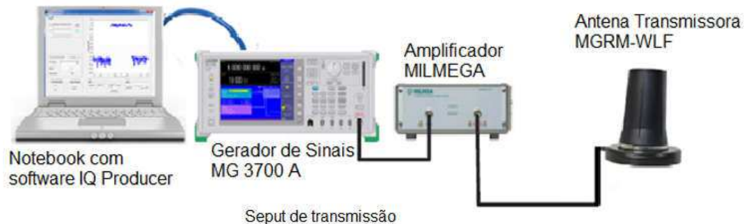
Figura 29: Setup de Transmissão
