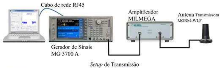
Figura 31: Setup de Transmissão.
