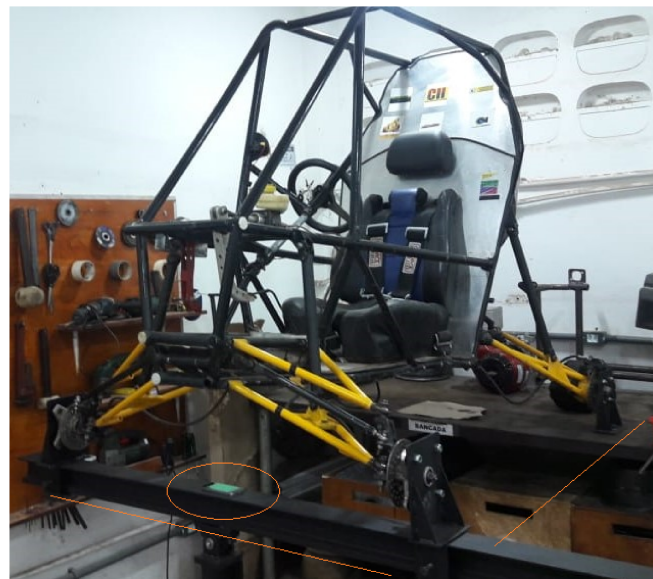
Figura 4.22 – Nivelamento da bancada. (Autor, 2018)
