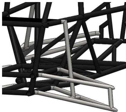
Figura 5.1 – Simplificação da geometria da suspensão. (Autor, 2018)
