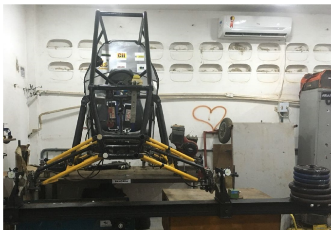
Figura 4.24 – Processo de aplicação de cargas. (Autor, 2018)
