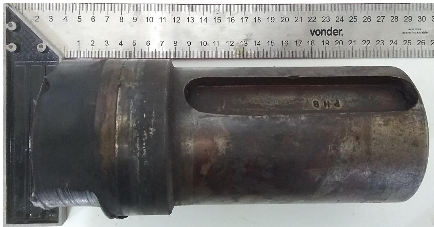
Figura 1.2 – Eixo fraturado do redutor de velocidade.
