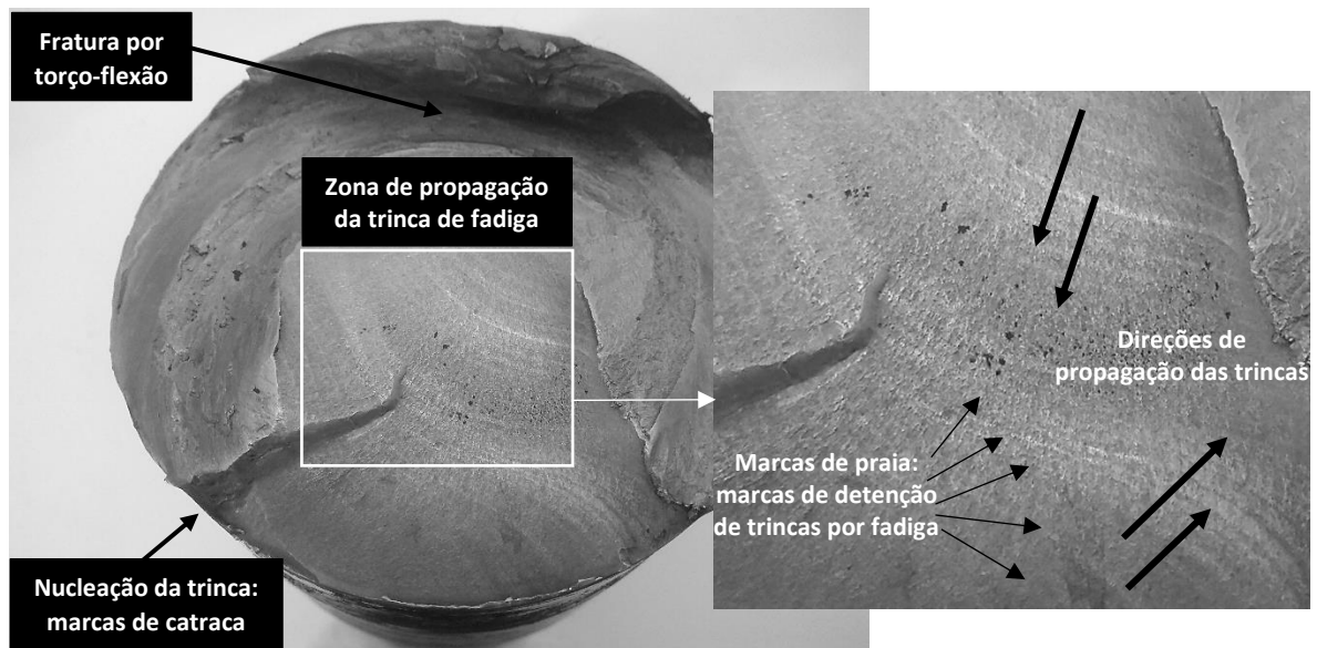
Figura 5.3 – Macrografia mostrando detalhes da superfície de fratura do eixo redutor.
