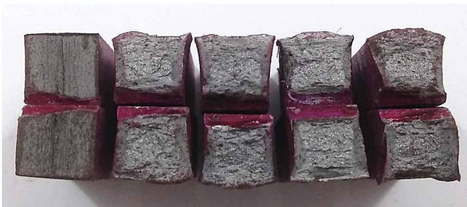
Figura 5.20 – Aspecto da superfície de fratura após ensaio de impacto Charpy em corpos de prova do material da peça na temperaturas ambiente.
