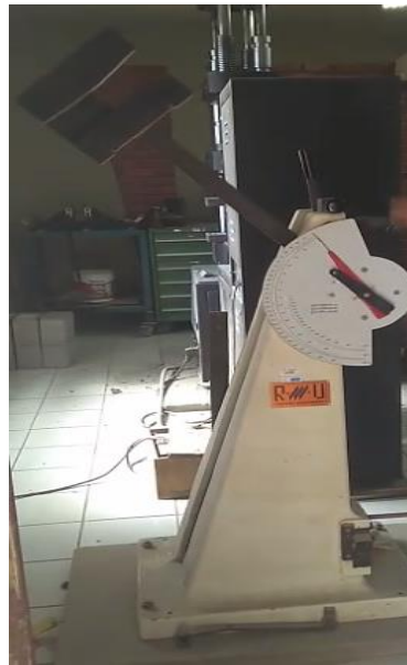
Figura 4.11 – Pendulo do ensaio de impacto Charpy.
