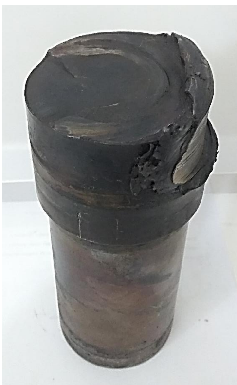
Figura 4.1 – Vista geral do eixo do redutor de velocidade fraturado.
