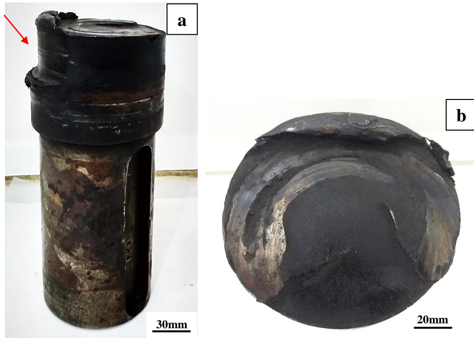
Figura 5.1 – Vistas do eixo fraturado: (a) vista lateral evidenciando a deformação plástica do material sob a superfície de fratura, (b) vista superior (superfície de fratura antes da limpeza).
