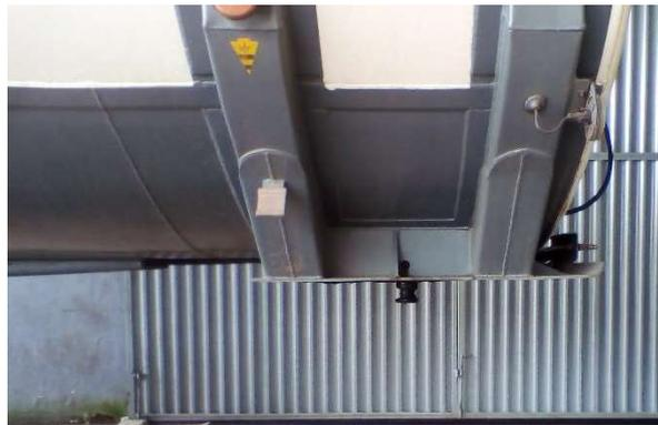
Figura 5.25: Visão lateral do disco acoplador. Fonte: Autor, 2019.
