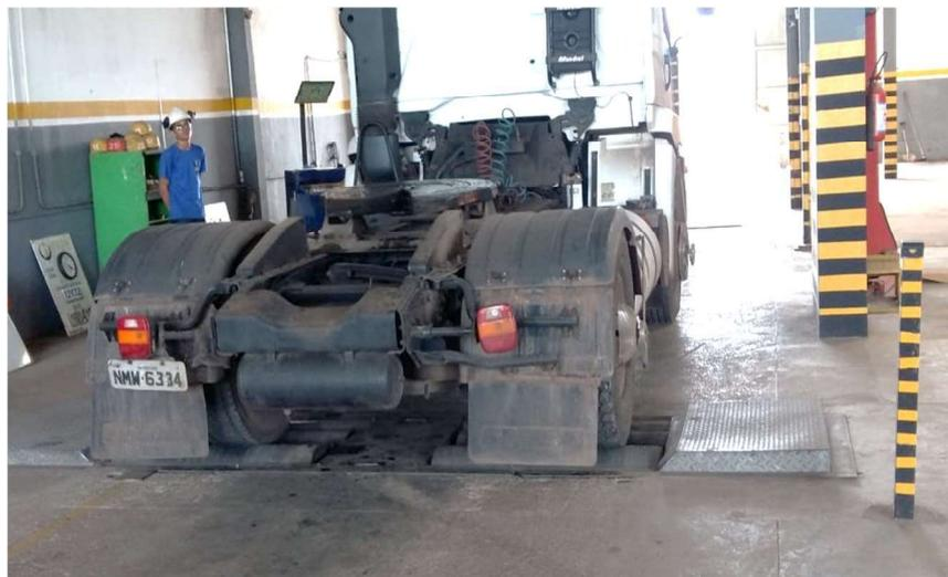
Figura 5.22: Teste de freio no eixo traseiro. Fonte: Autor, 2019.
