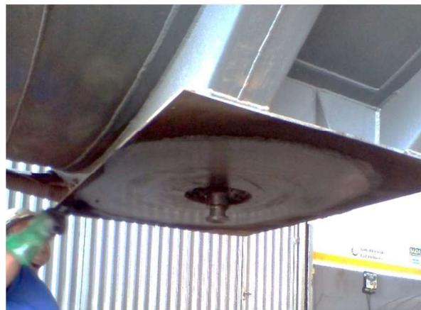
Figura 5.26: Visão inferior do disco acoplador. Fonte: Autor, 2019.
