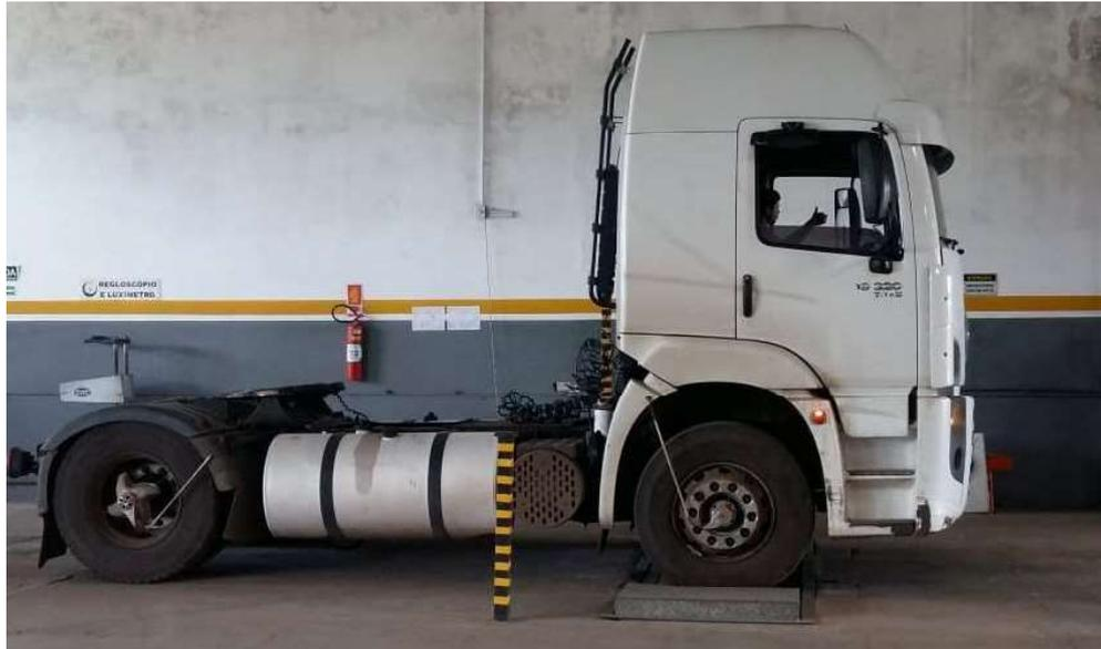
Figura 5.21: Teste de freio no eixo dianteiro. Fonte: Autor, 2019.
