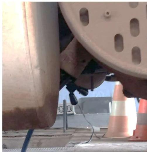
Figura 5.24: Opacímetro conectado as escapamento. Fonte: Autor, 2019.
