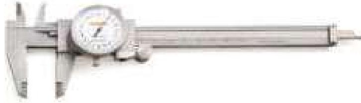
Figura 5.10: Paquímetro universal com relógio. Fonte: Régua Online, 2012.
