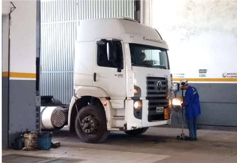
Figura 5.19: Inspeção no farol esquerdo. Fonte: Autor, 2019.
