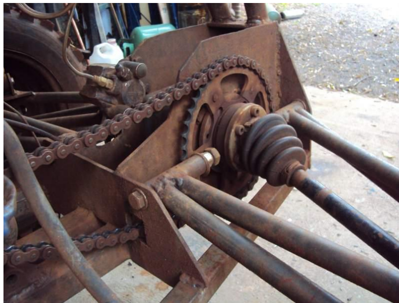
Figura 4.5 - Redução secundária por pinhão, coroa e corrente (Adaptado de 4x4brasil, 2012).
