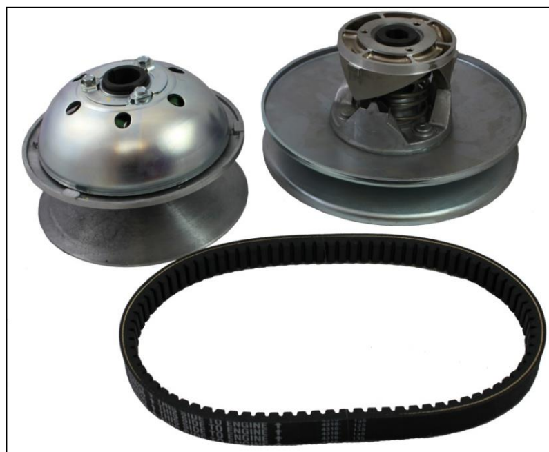
Figura 5.1 - CVT modelo Comet 780 usada pela equipe BMB (Adaptado de MPN, 2017).
