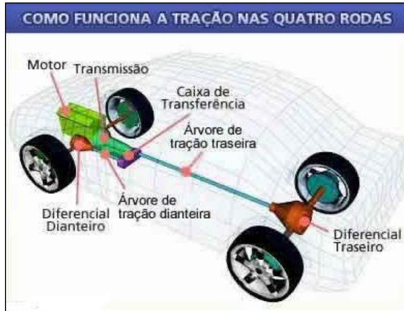
Figura 4.2 - Sistema de transmissão de um veículo 4x4 (Adaptado de Autoentusiastas, 2015).
