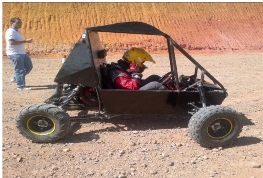
Figura 4.8 - Veículo Baja com carenagem feita com fibra de vidro (Adaptado de Sartor et al, 2013).
