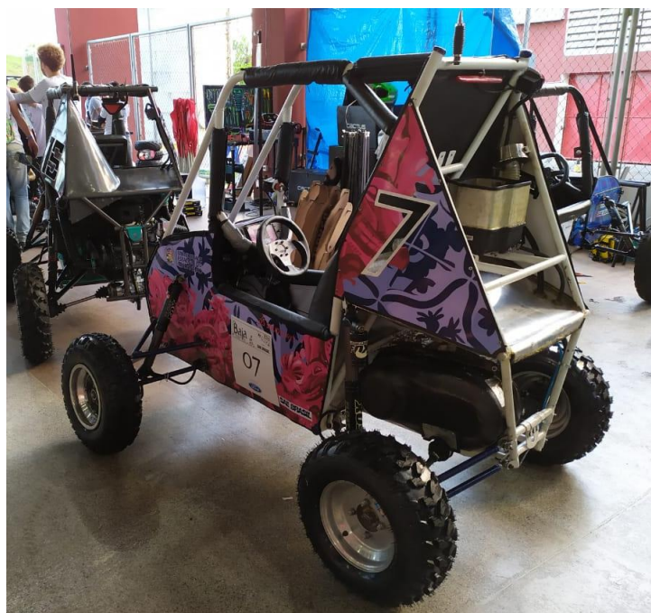
Figura 5.4 - Carenagem lateral e traseira em polietileno ano 2019 equipe Bumba Meu Baja (Valverde, 2019).
