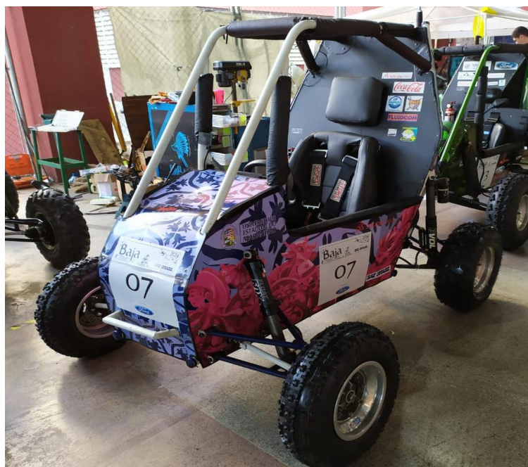
Figura 5.3 - Carenagem frontal e lateral em polietileno ano 2019 equipe Bumba Meu Baja (Valverde, 2019).
