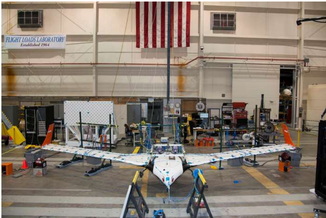
Figura 3.15: Ensaio Ground Test Vibration em drone pertencente a NASA (2014)
