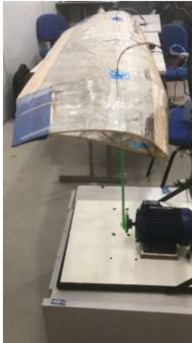
Figura 5.18: Montagem do experimento com fixação dos acelerômetros, motor e inversor de frequência (AUTOR,2019)
