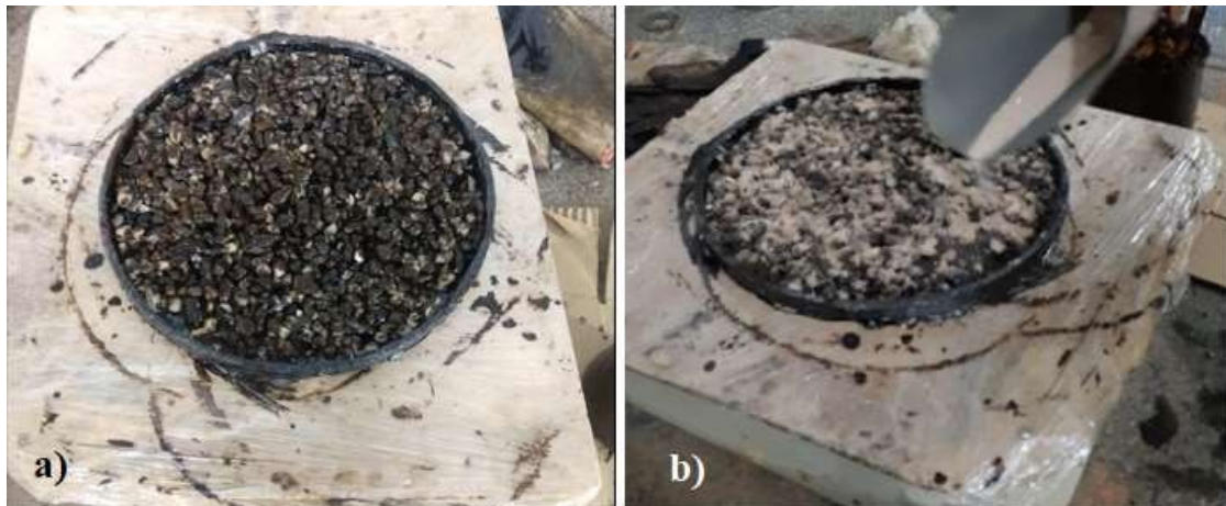
Figura 31 - Aplicação do banho diluído (a); Espalhamento da areia (b).
