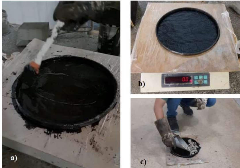
Figura 29 - Aplicação do ligante (a); Pesagem do conjunto (b); espalhamento do agregado (c).
