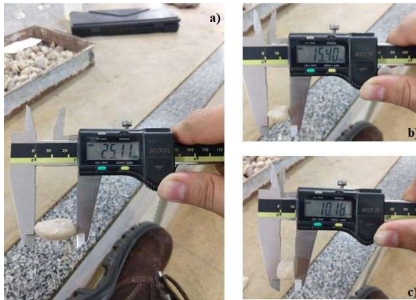
Figura 20 - Determinação do índice de forma com paquímetro: dimensões a, b e c do agregado.
