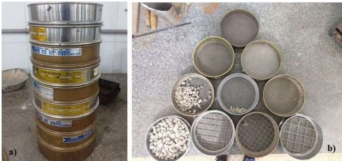
Figura 17 - Conjunto de peneiras (a) e material retido em cada uma delas (b).
