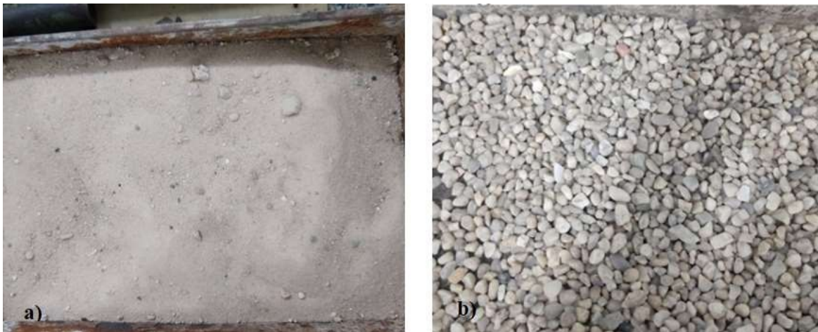
Figura 15 - Areia (a) e seixo rolado (b) utilizados nesse estudo.
