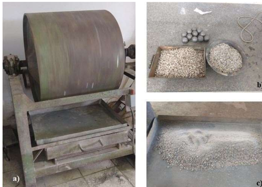
Figura 18 - Ensaio de abrasão Los Angeles : material sendo sujeito a revoluções dentro da máquina (a); material separado com a carga abrasiva (b); material após o desgaste e antes da lavagem (c).
