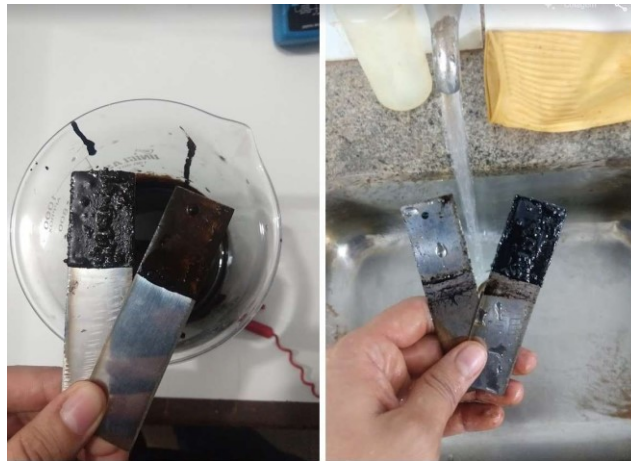
Figura 36 - Depósito de emulsão
