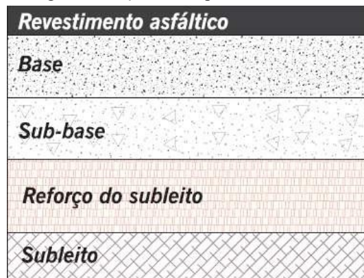
Figura 2 - Seção de um pavimento flexível.
