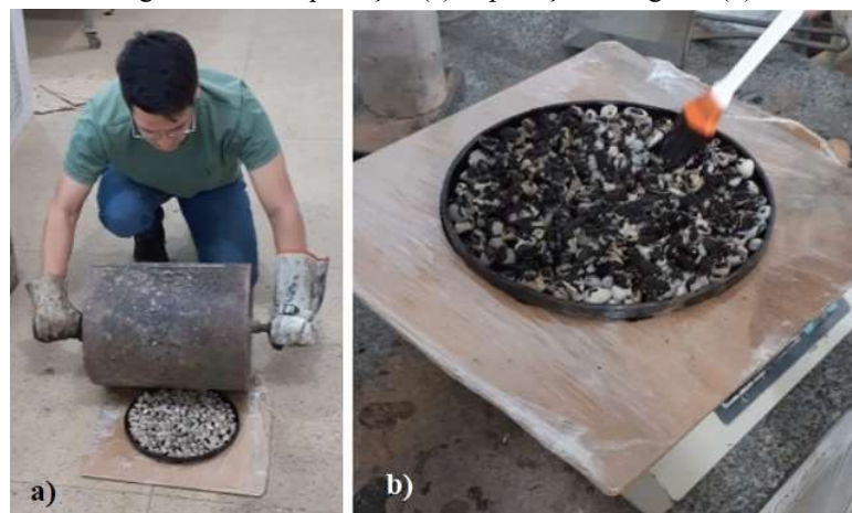
Figura 30 - Compactação (a); Aplicação do ligante (b).
