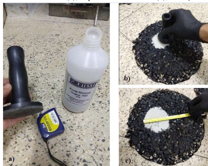
Figura 33 - Materiais utilizados (a); Espalhamento da areia (b); Medição do diâmetro (c).
