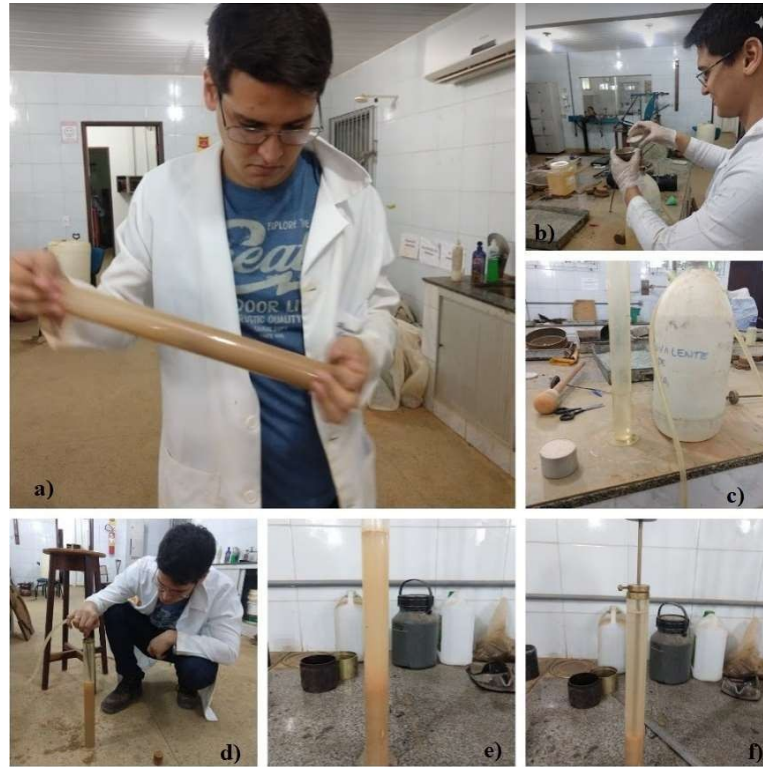
Figura 21 - Ensaio de Equivalente de areia: (a) agitação; (b) adição do agregado; (c) solução diluída e tubo de ensaio; (d) adição da solução e lavagem das paredes do tubo; (e) repouso; (f) pistão com peso.
