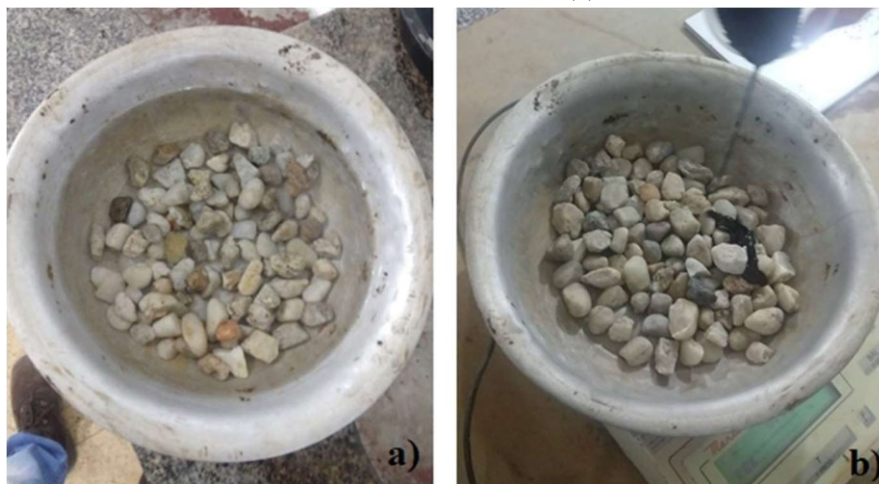
Figura 19 - Ensaio de Adesividade: Material a ser lavado em água destilada por 1 minuto (a); adição de 17,5g de emulsão asfáltica RR-2C (b).
