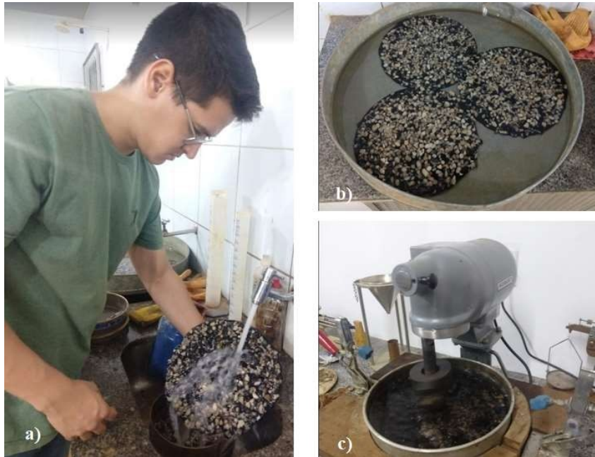
Figura 32 - Lavagem da manta (a); Mantas submersas (b); Manta submetida ao desgaste (c).
