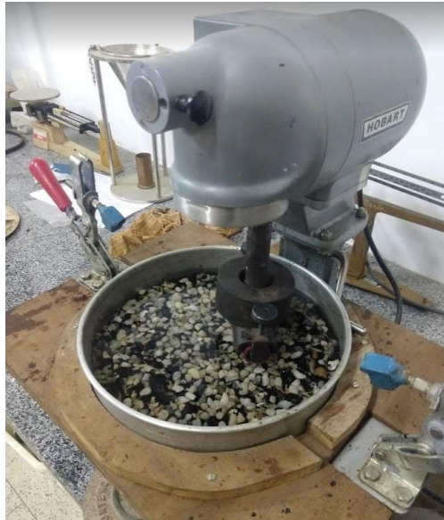
Figura 27- Máquina utilizada no ensaio WTAT.
