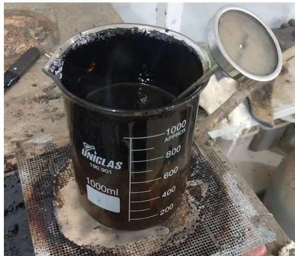
Figura 24 - Água evaporando da emulsão
