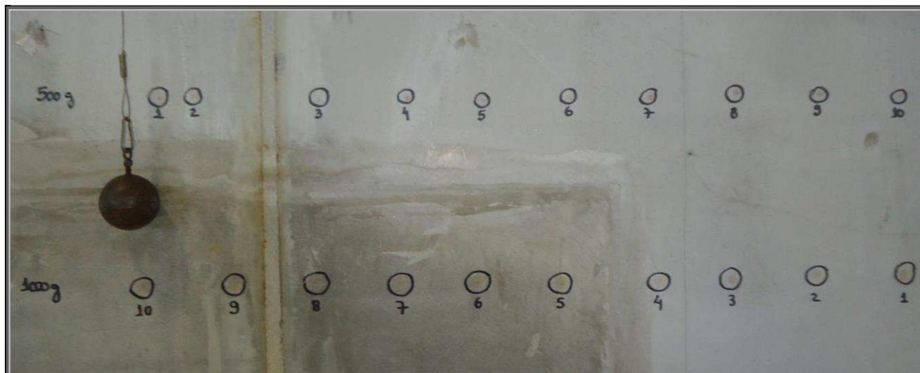
**Figura 5** – Marcações dos impactos realizados pelo corpo duro na parede.
