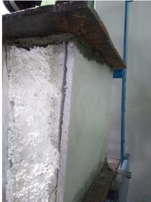
Figura 6 : Bloco 1 rompido após carregamento
