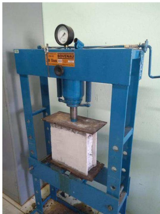
Figura 5: Prensa Hidráulica com bloco capeado
