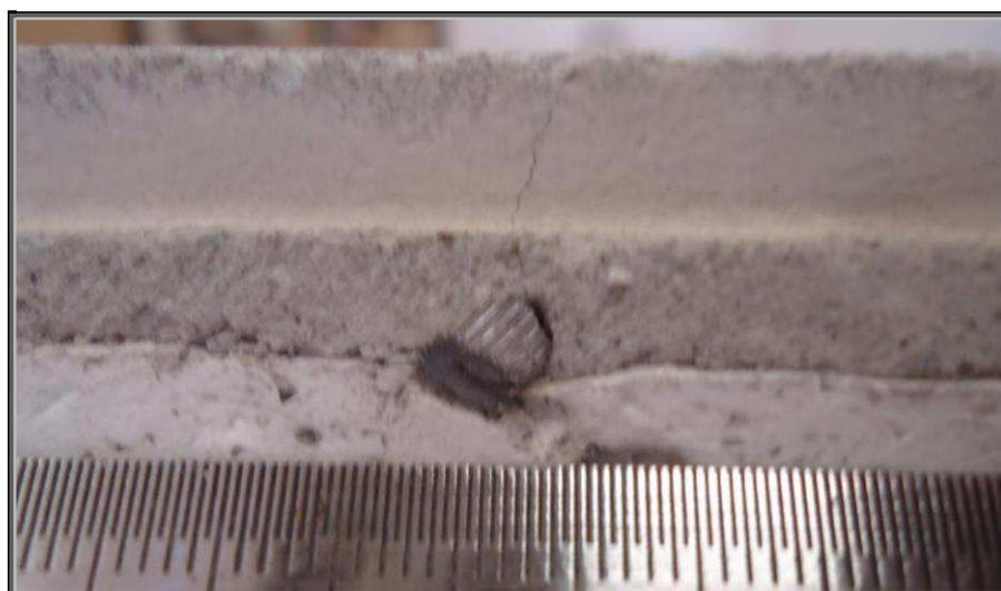
**Figura 10** – Fissuras no alinhamento da tela armada.
