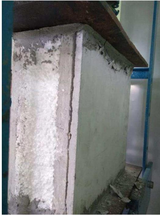
Figura 8: Bloco 3 rompido após carregamento
