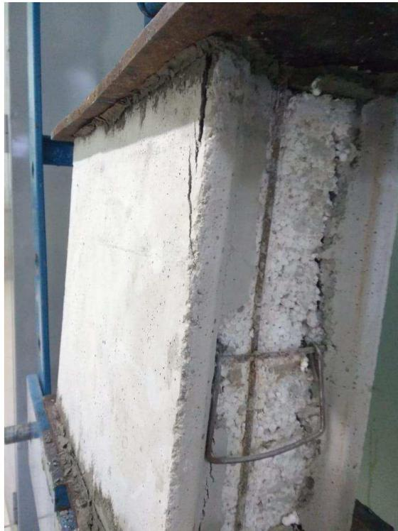
Figura 7: Bloco 2 rompido após carregamento
