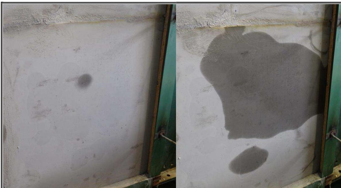
**Figura 3** – Manchas de umidade na face oposta à incidência de água antes (esquerda) e após (direita) o envelhecimento.
