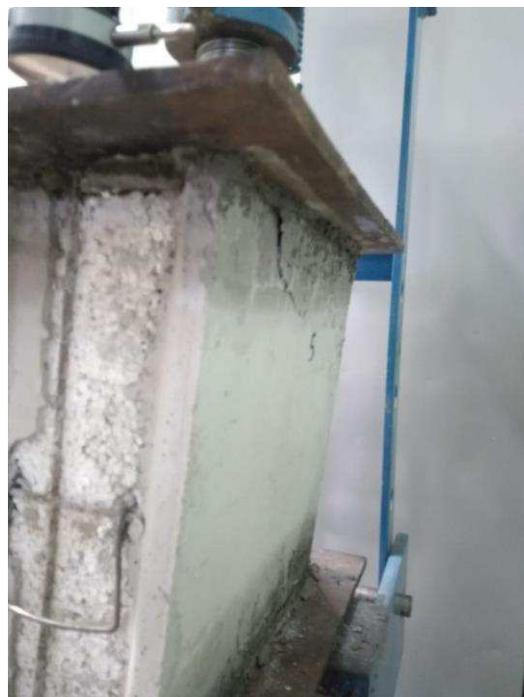
Figura 9: Bloco 4 rompido após carregamento
