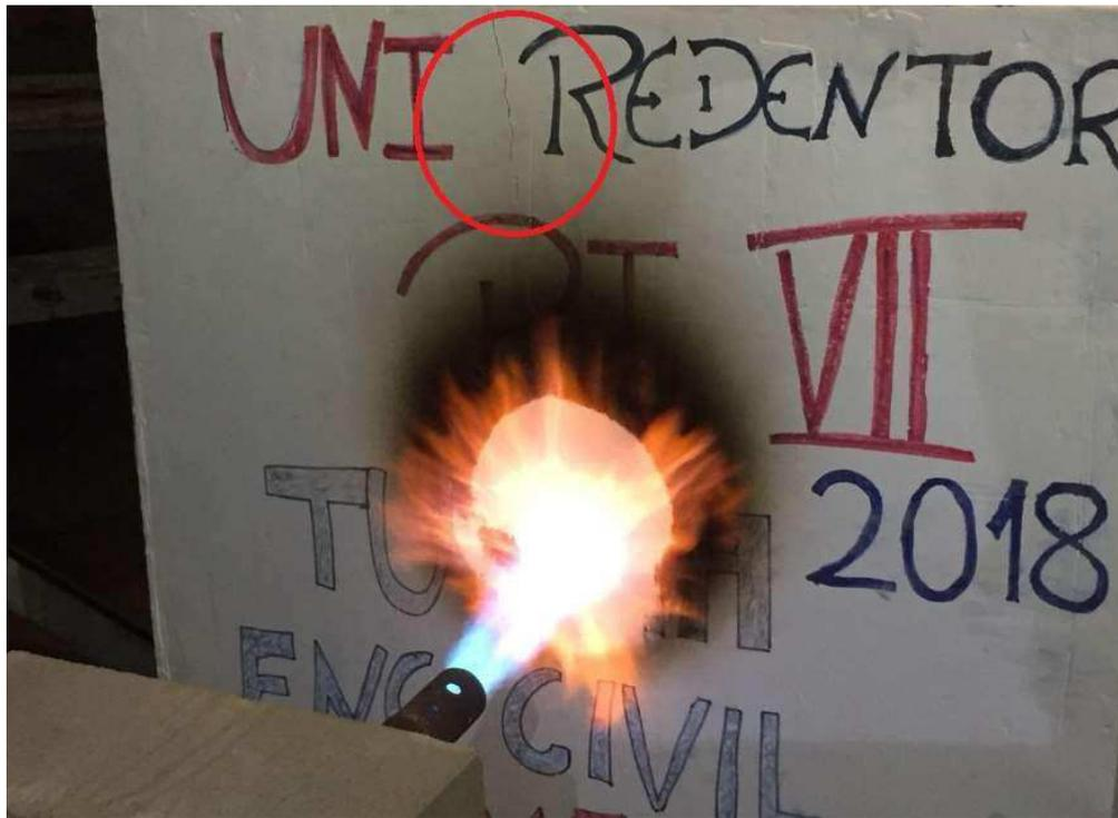
*Imagem 4: fissura na parte superior do bloco*
