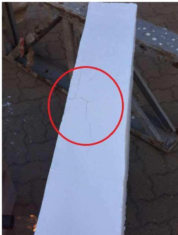
*Imagem 3: fissura no topo do bloco*
