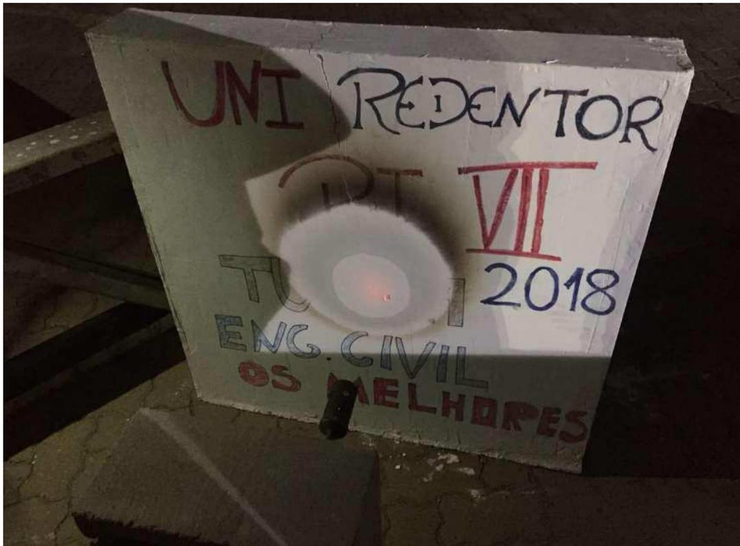
Imagem 9: Bloco após 1 Hora e 30 minutos de ensaio
