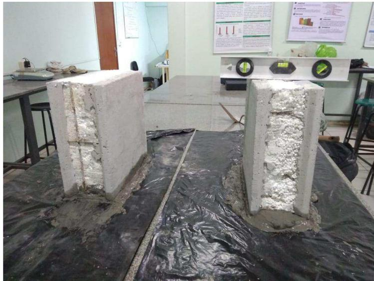
Figura 4: Corpo-de-prova capeado e nivelado
