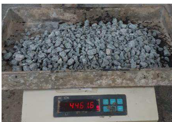
Figura 14 – Brita 1 resultante do ensaio de abrasão Los Angeles
