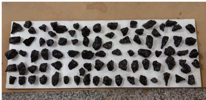
Figura 26 - Adesividade insatisfatória da Brita 1.
