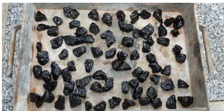
Figura 27 - Adesividade Satisfatória da brita 1 com acréscimo de ligante
