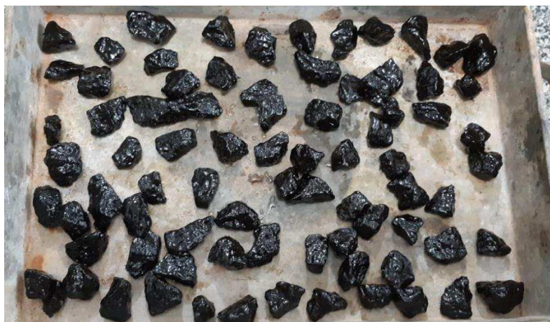
Figura 12 – Amostra de agregado submetida ao ensaio de adesividade
