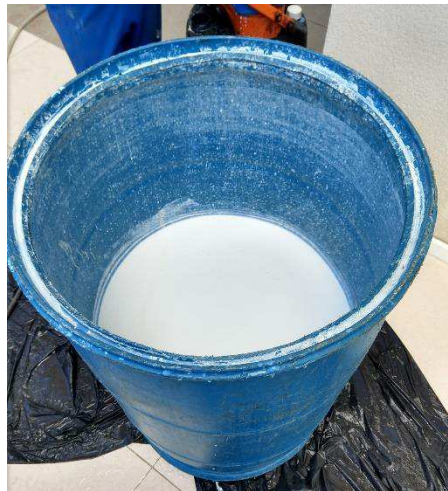
Figura 51 - Hidrofugante empedado na proteção de revestimento
