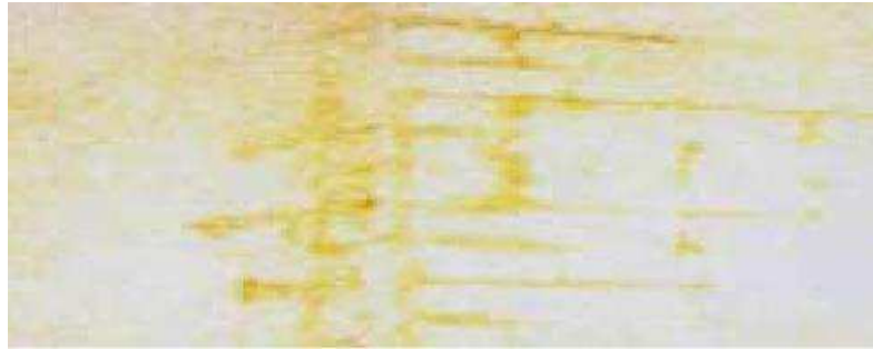
Figura 28 - Cisalhamento do substrato
