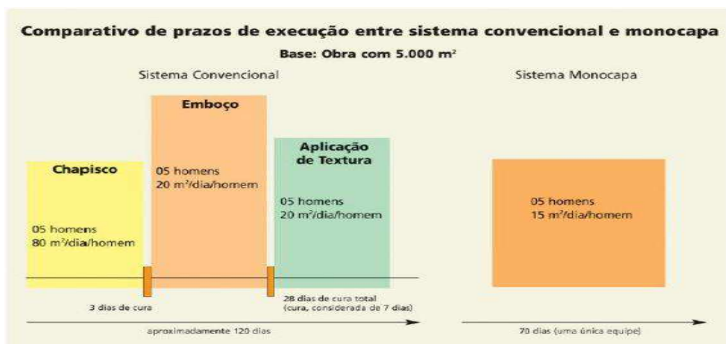
Figura 22 - Comparativo de prazos de execução dos revestimentos tradicional e monocamada
