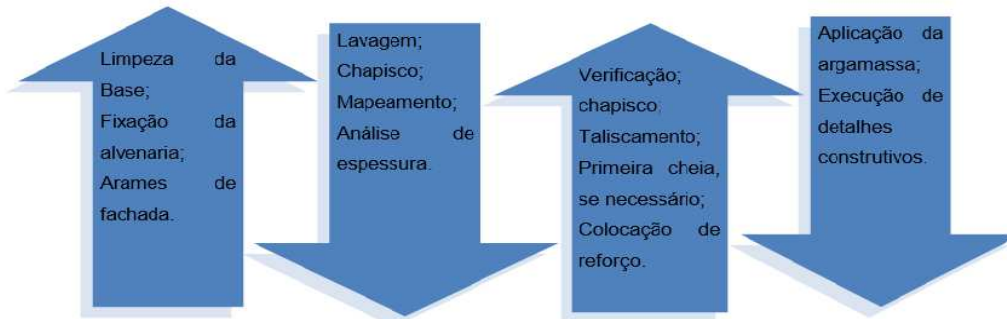
Figura 23 - Subida e descida de balancim – execução de fachada através do sistema convencional
