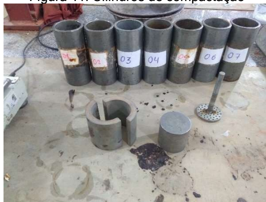
Figura 41: Cilindros de compactação
