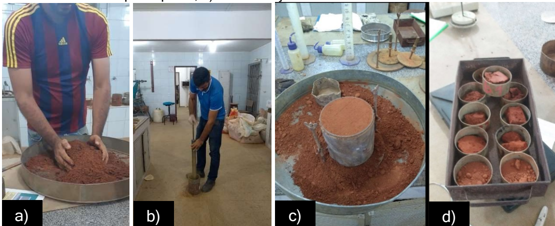
Figura 38: a) preparação da amostra; b) compactação; c) nivelamento da amostra e pesagem do corpo de prova; d) determinação da umidade das amostras
