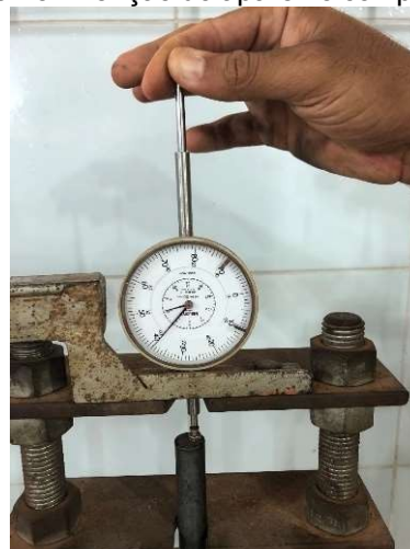
Figura 43: Aferição do aparelho compactador
