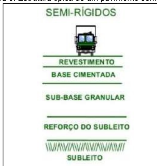
Figura 3: Estrutura típica de um pavimento semi-rígido
