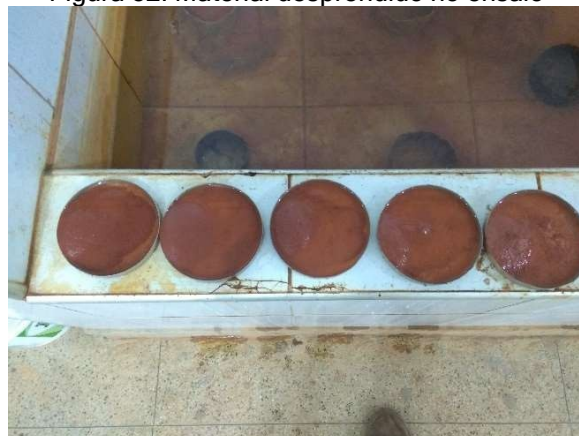
Figura 52: Material desprendido no ensaio
