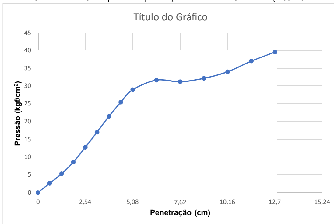
Gráfico 4.12 – Curva pressão x penetração do ensaio de CBR do traço 30A70S
