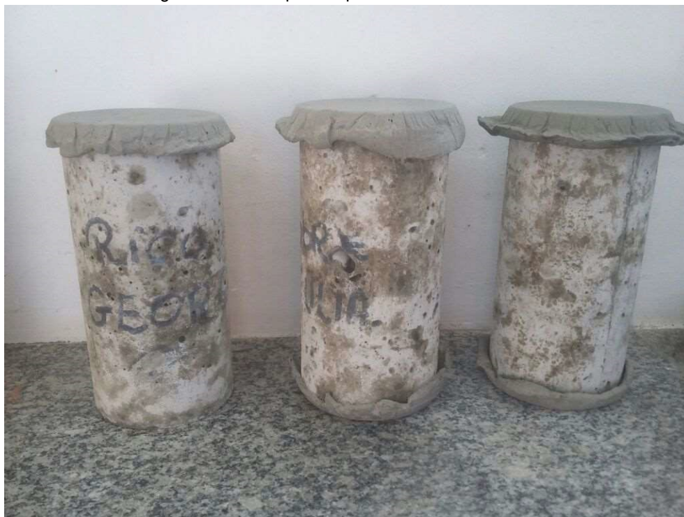
Figura 2.11 – Corpos de prova conservados ao ar
