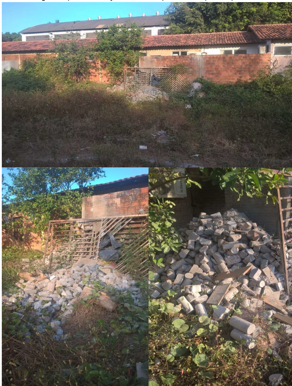
Figura 2.5 – Entulho gerado pela destinação final inadequada de corpos de prova de concreto na UEMA
