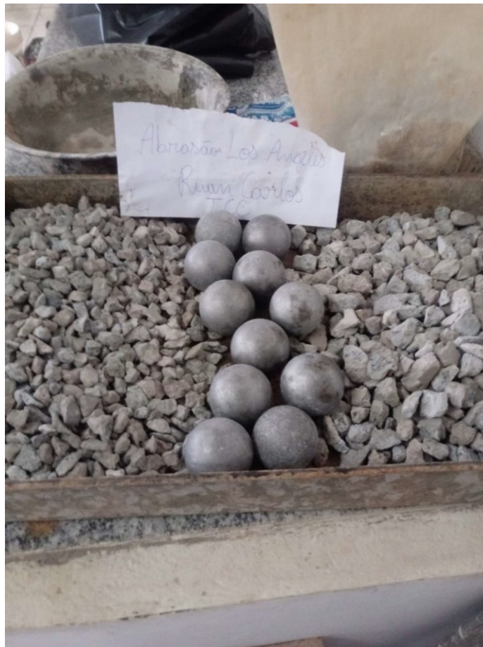
Figura 3.22 – Amostra utilizada em ensaio de abrasão Los Angeles e carga abrasiva
