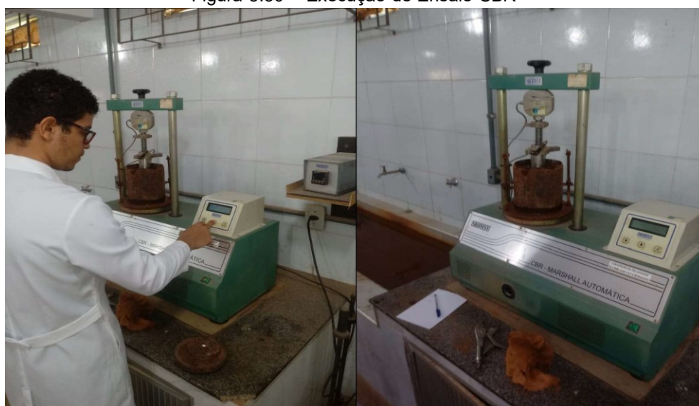
Figura 3.30 – Execução de Ensaio CBR
