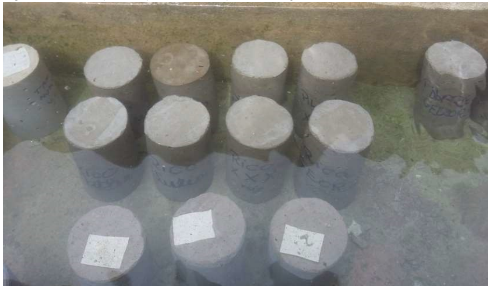
Figura 2.10 – Corpos de prova em tanque de solução saturada de hidróxido de cálcio
