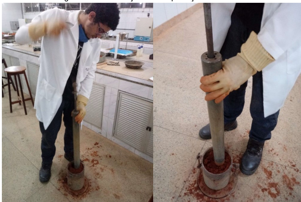
Figura 3.25 – Execução de compactação de camadas
