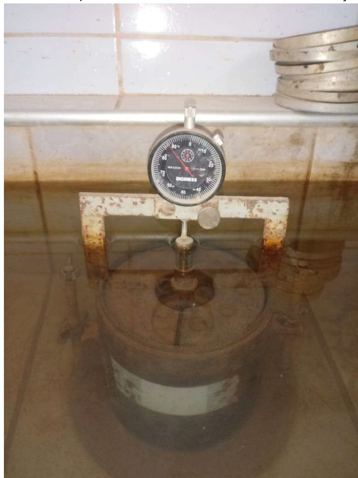
Figura 3.28 – Amostra compactada no molde cilíndrico em imersão e aferição da expansão
