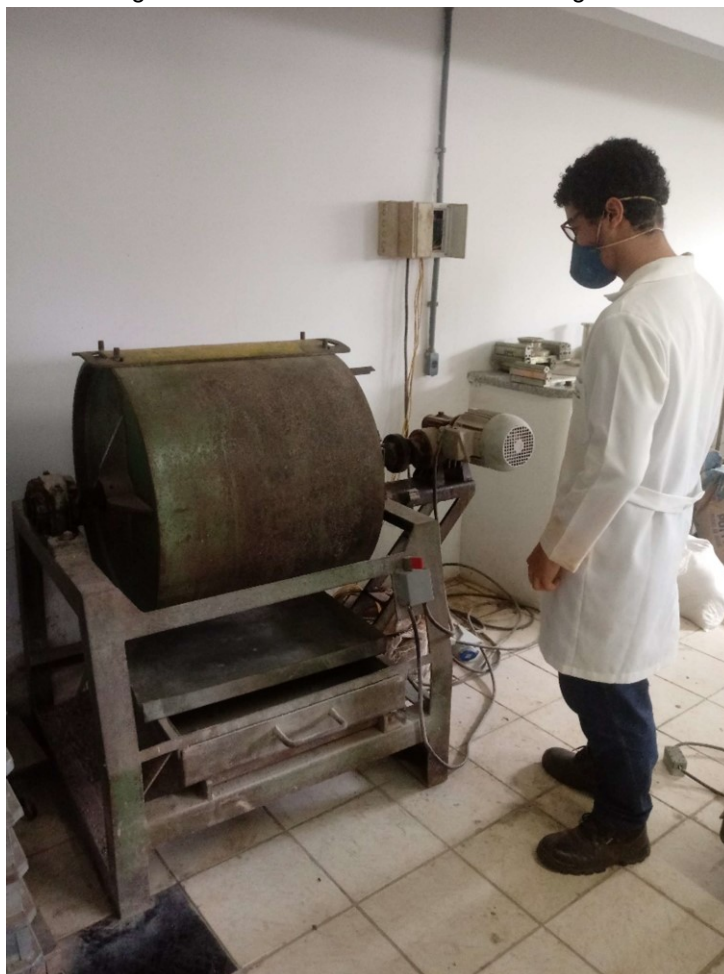
Figura 3.23 – Ensaio de abrasão Los Angeles
