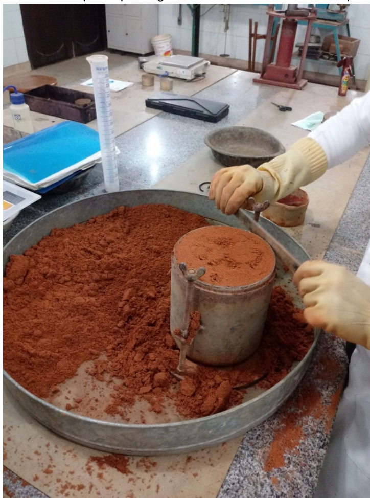
Figura 3.26 – Corpo de prova gerado durante o ensaio de compactação
