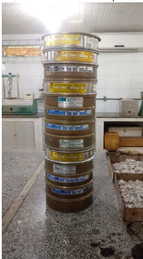
Figura 3.11 – Peneiras utilizadas no peneiramento
