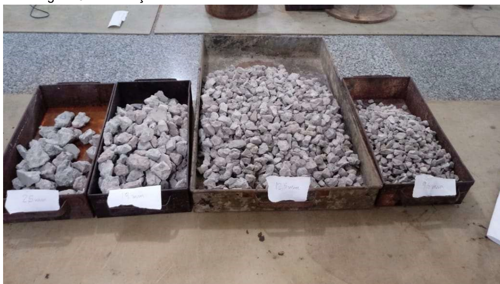
Figura 3.14 – Frações da amostra utilizadas no ensaio do índice de forma
