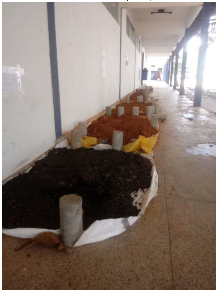
Figura 2.17 – Reaproveitamento de corpos de prova de concreto para fixação de lonas e divisão de amostras de solo (UEMA)
