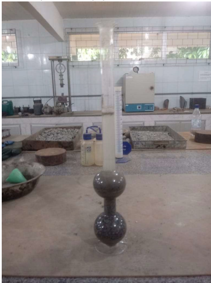
Figura 3.19 – Fração miúda do agregado em ensaio no frasco de Chapman
