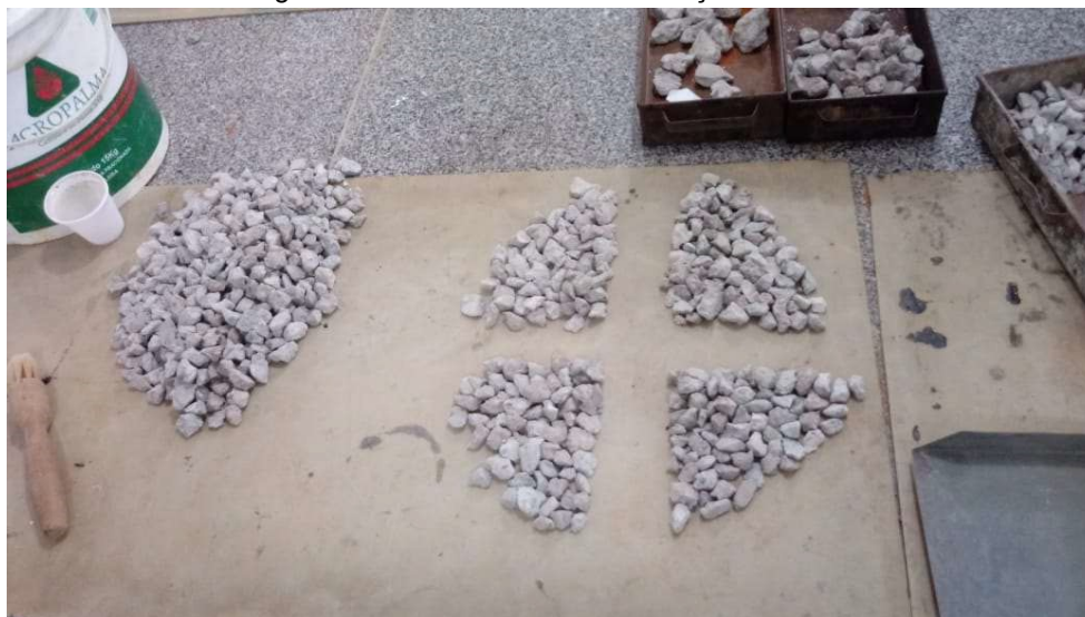
Figura 3.15 – Quarteamento de frações retidas
