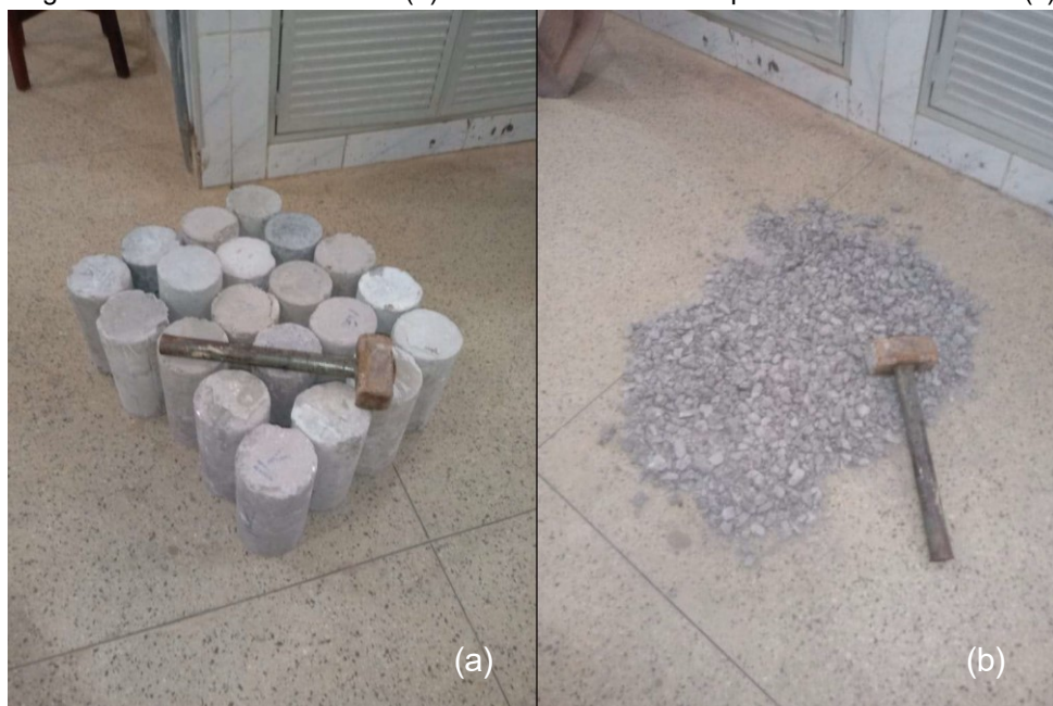
Figura 3.5 – Amostra coletada (a) e amostra reduzida e quebrada manualmente (b)
