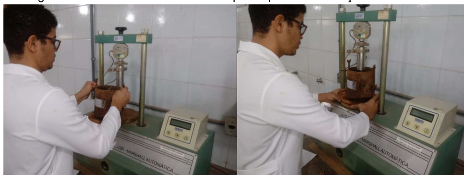
Figura 3.29 – Posicionamento de corpo de prova e execução de ensaio CBR
