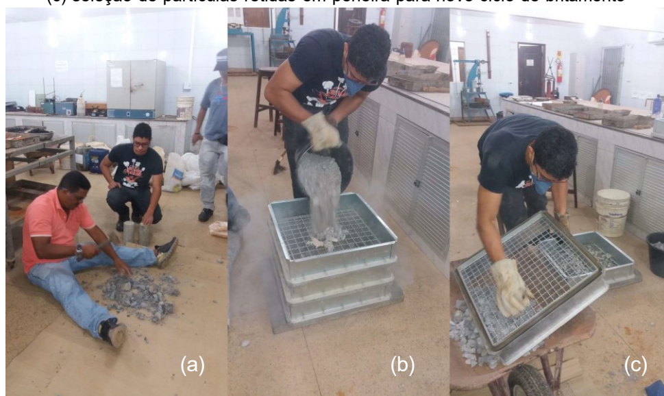
Figura 3.6 – Etapas de quebra do material: (a) britamento manual; (b) peneiramento do material britado; (c) seleção de partículas retidas em peneira para novo ciclo de britamento
