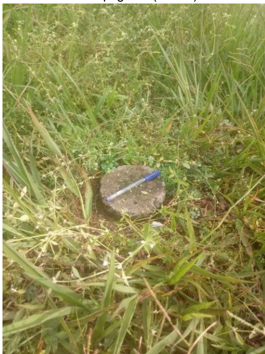
Figura 2.15 – Reaproveitamento de corpos de prova para utilização como marco topográfico para aulas de Topografia (UEMA)
