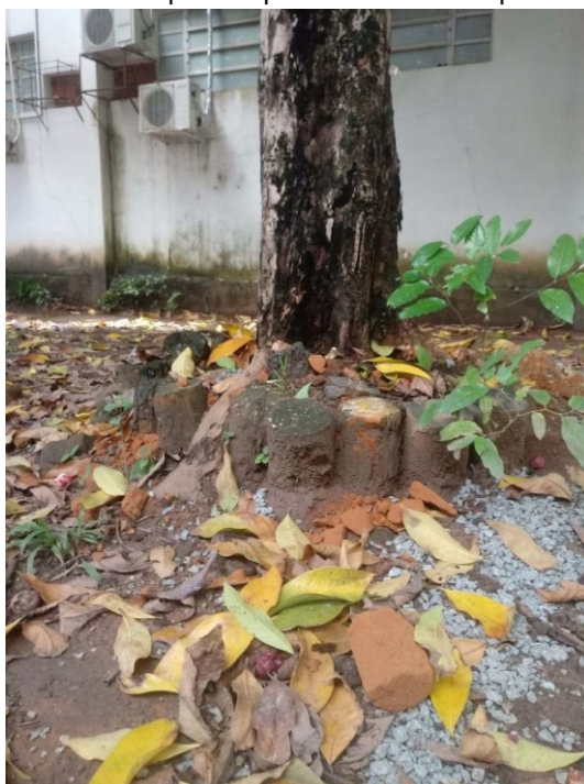
Figura 2.16 – Reaproveitamento de corpos de prova de concreto para canteiros de árvores (UEMA)
