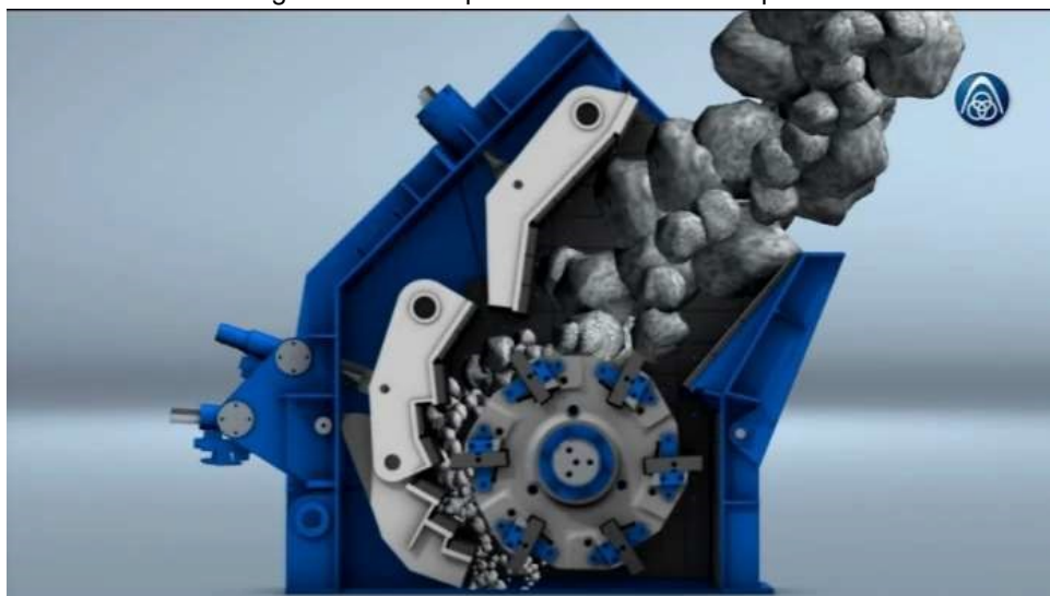
Figura 2.19 – Esquema de britador de impacto
