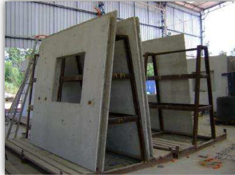
Figura 34 - Estocagem dos painéis
