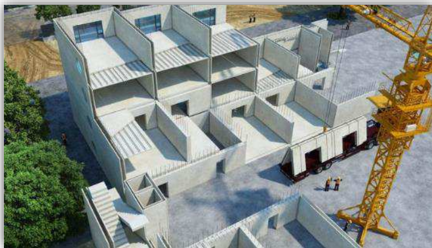
Figura 27 - Maquete de obra utilizando painel de parede dupla
