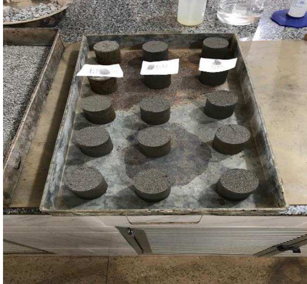
Figura 32 – corpos de prova desmoldados e separados de acordo com o traço (1:10; 1:12 e 1:14 da esquerda para a direita).
