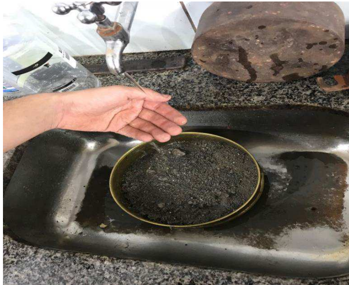
Figura 15 – Peneiramento por lavagem
