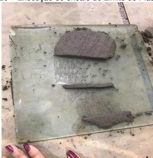
Figura 20 – Execução do ensaio de Limite de Plasticidade
