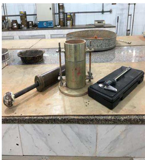
Figura 21 – material ensaio pronto (soquete, cilindro metálico e régua de precisão)
