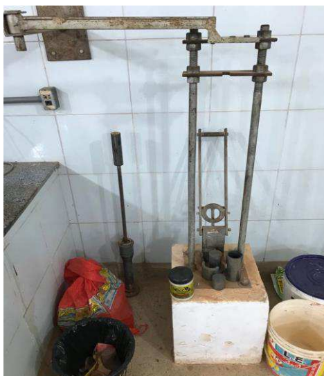
Figura 27 – Equipamento de compactação em miniatura
