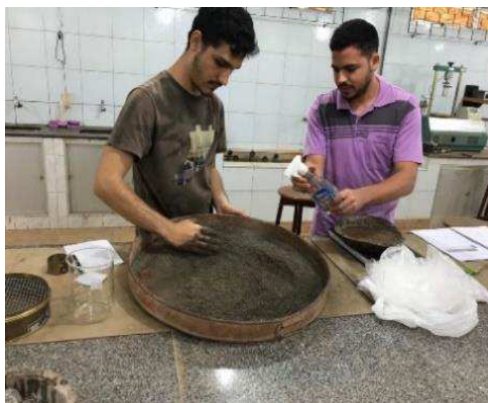
Figura 22 – passo a passo do ensaio (homogeneização solo água)
