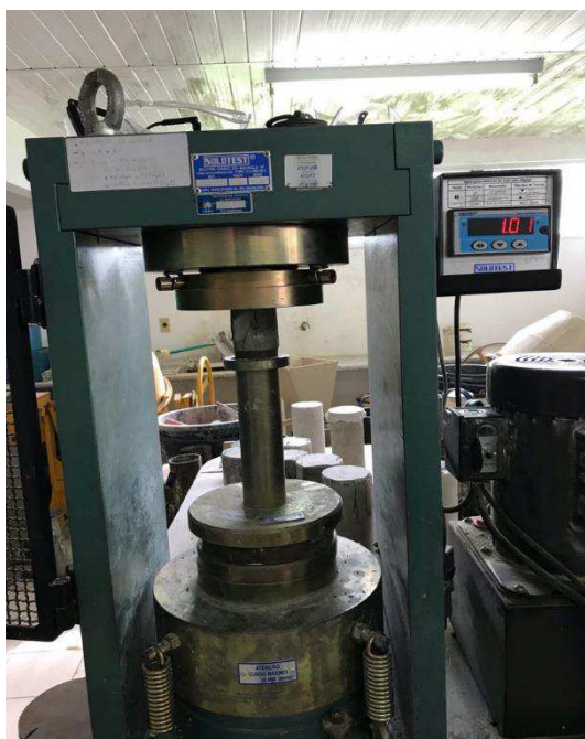
Figura 37 – Execução do ensaio de compressão
