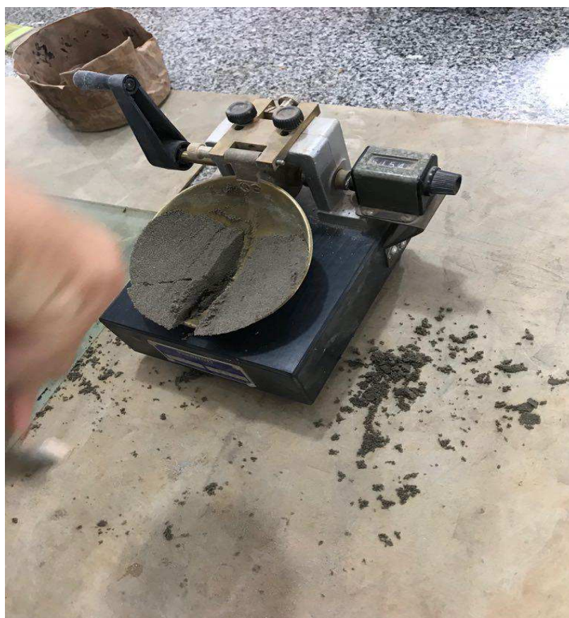
Figura 19 – Execução do ensaio de Limite de Liquidez
