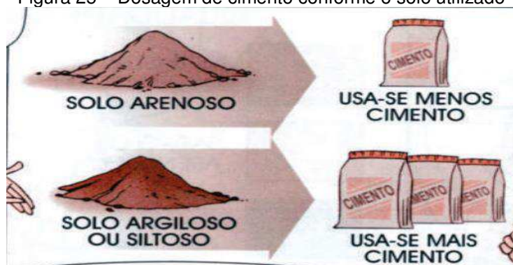
Figura 25 – Dosagem de cimento conforme o solo utilizado
