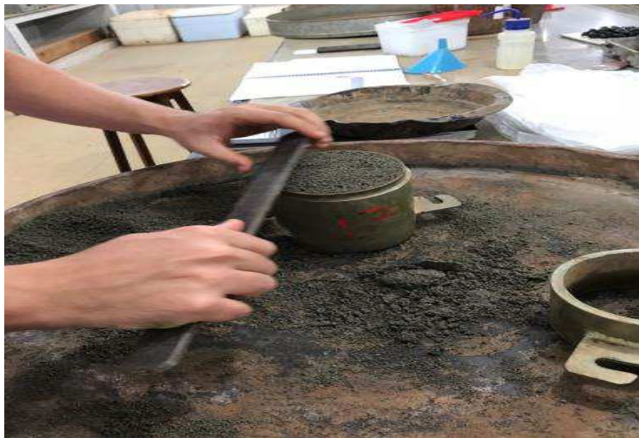
Figura 24 - Regulação do material compactado no cilindro.
