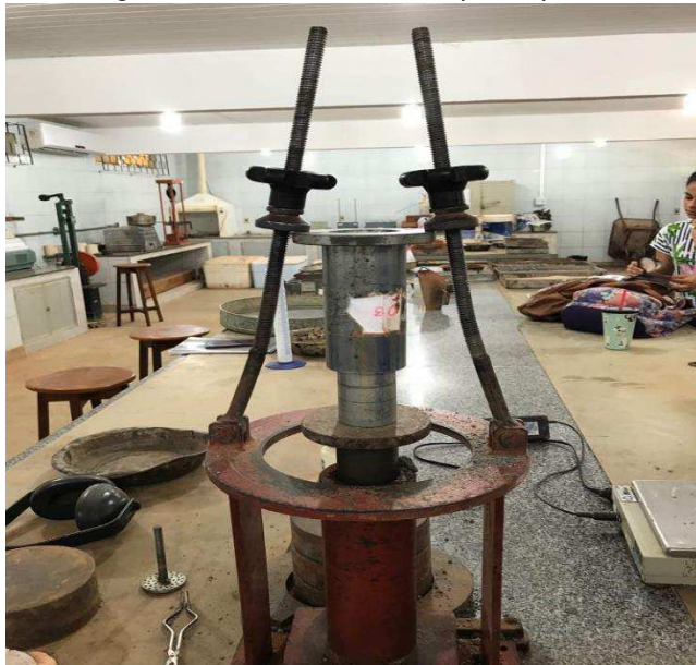
Figura 31 – desmolde do corpo de prova
