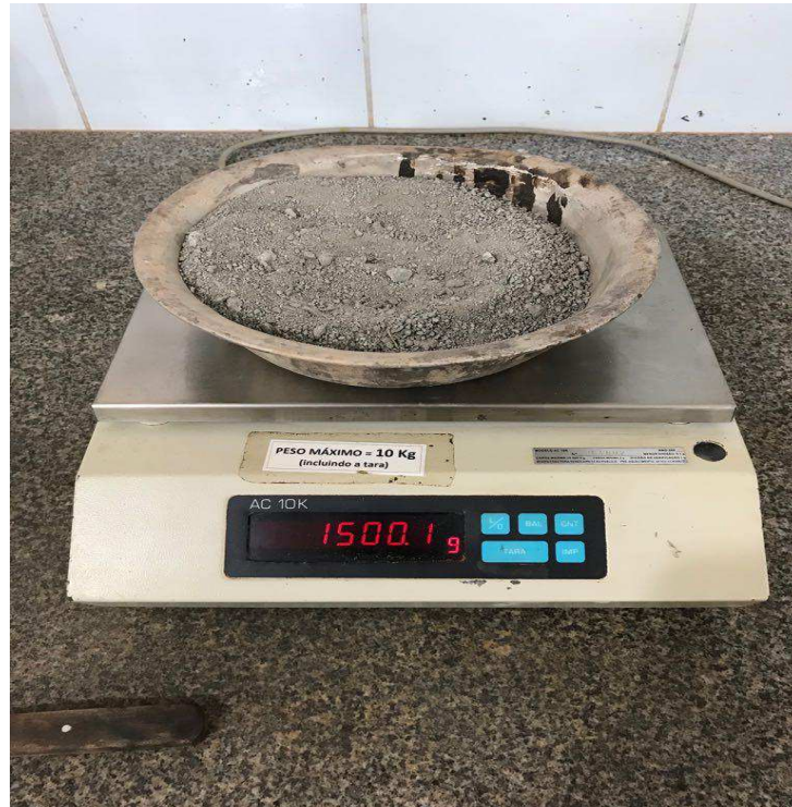
Figura 13 – Solo destorroadado medição da massa
