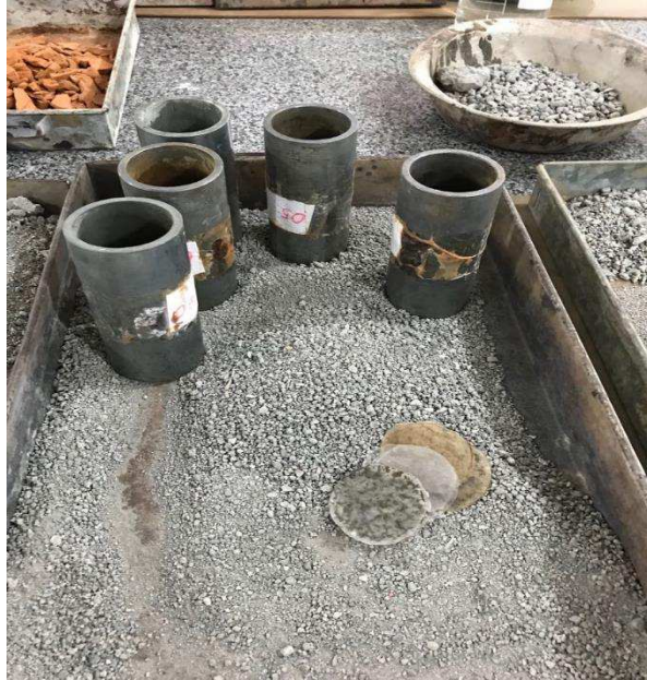
Figura 30 – corpos de prova ainda nos moldes
