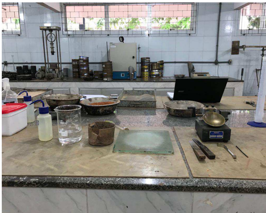
Figura 18 – Materiais para ensaios de determinação dos limites de consistência do solo
