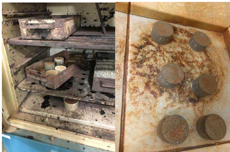
Figura 39 – Corpos de prova na estufa e depois imersos em água
