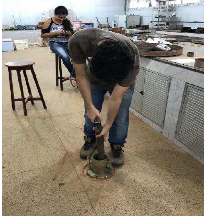
Figura 23 - Compactação do solo no cilindro metálico com o soquete.
