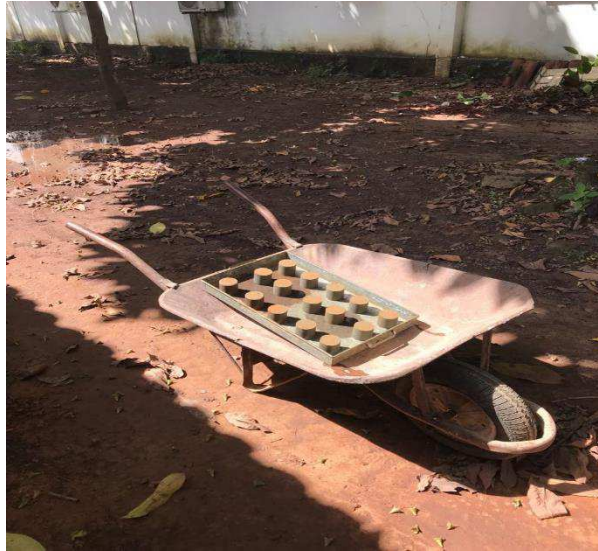
Figura 35 – Corpos de prova secando ao ar livre
