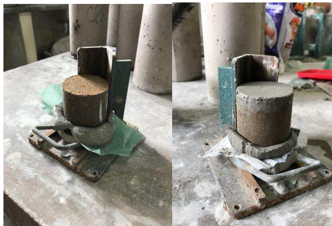
Figura 36 – Sequência de capeamento dos corpos de prova
