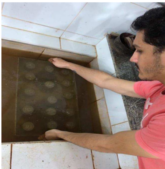
Figura 33 – Corpos de prova em processo de cura
