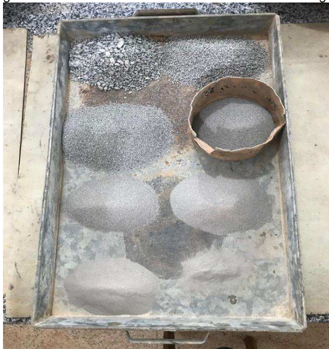
Figura 17 – Granulometria do solo sem os finos da lavagem
