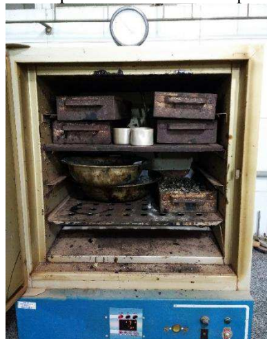
Figura 24 - Amostras colocadas separadamente na estufa após imersão em sulfato de sódio
