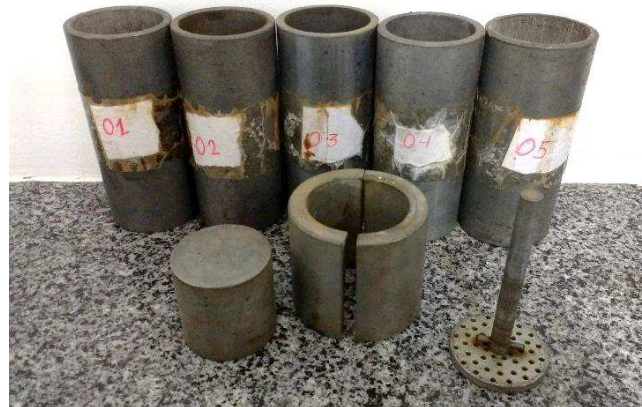
Figura 18 – Moldes miniatura e acessórios utilizados no ensaio Mini-MCV
