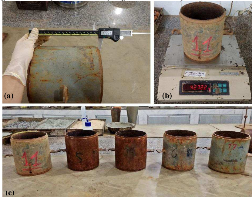
Figura 29 - Aferição de medidas e pesagem dos cilindros para o cálculo do volume
