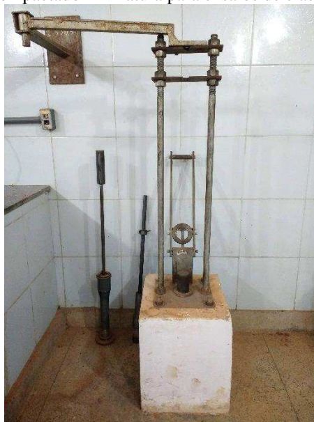
Figura 17 - Compactador miniatura para ensaios de classificação MCT
