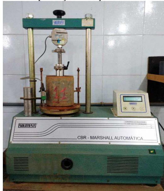
Figura 35 - Ensaio de penetração na máquina CBR-Marshall automática
