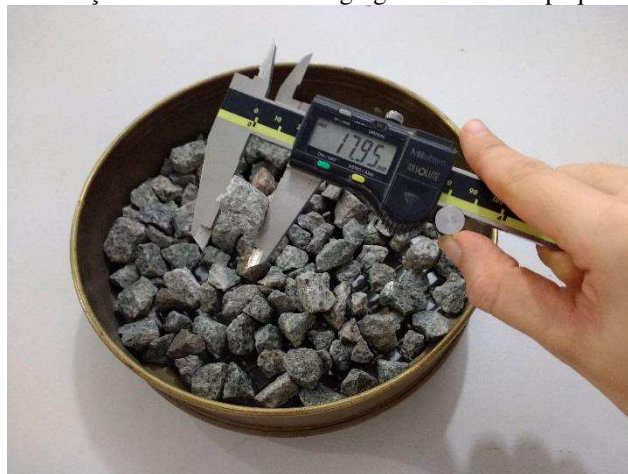
Figura 27 – Aferição das dimensões do agregado utilizando paquímetro digital
