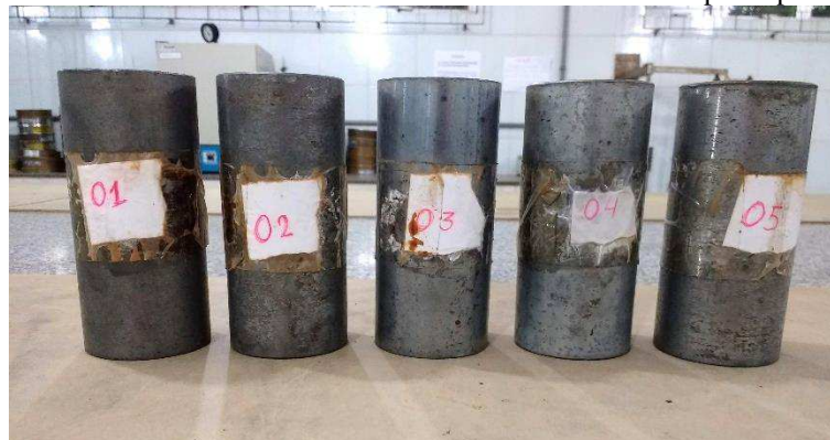
Figura 15 - Moldes cilíndricos utilizados no ensaio Mini-MCV e perda por imersão
