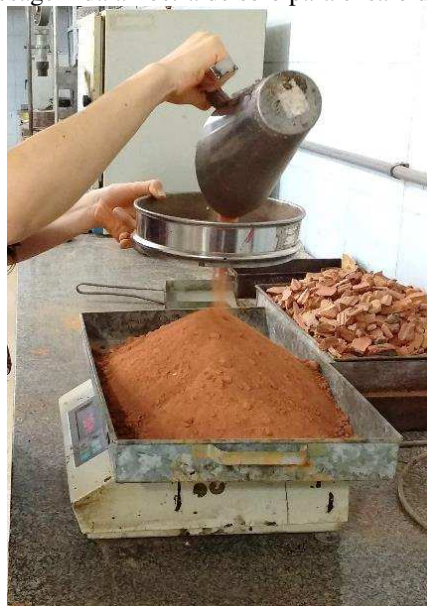
Figura 28 - Pesagem da amostra de solo para ensaio de compactação
