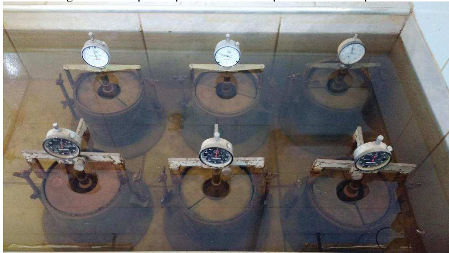
Figura 34 - Corpos de prova em imersão para ensaio de expansão
