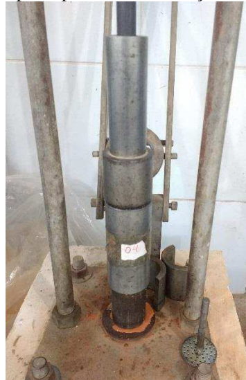
Figura 21 - Corpo de prova com exsudação excessiva na base
