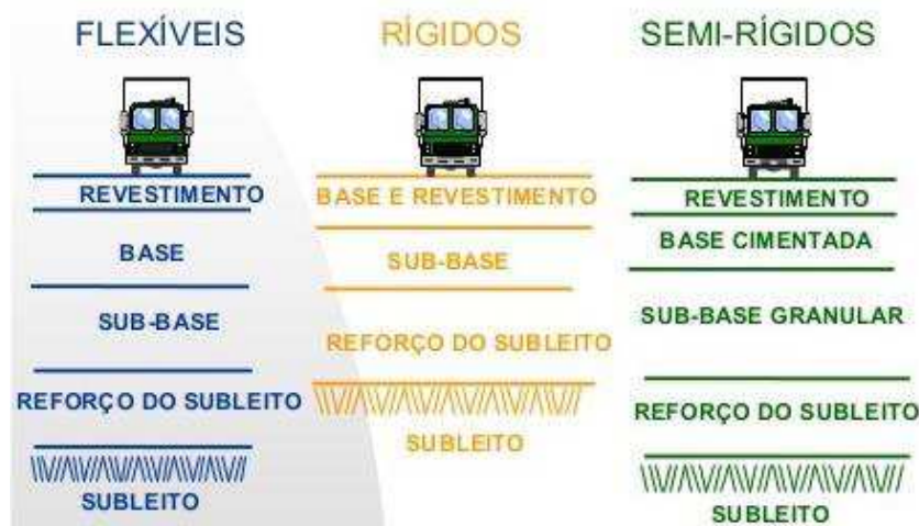
Figura 2 - Estrutura dos tipos de pavimentos
