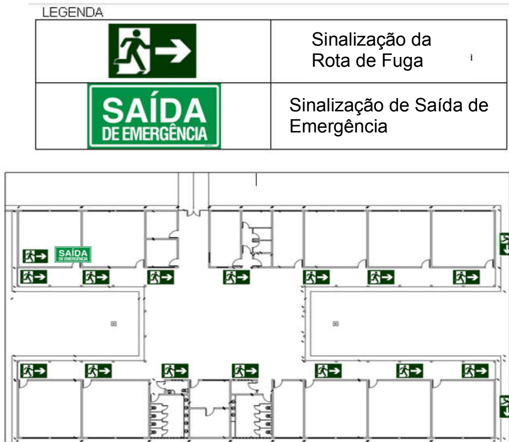
Figura 25 - Planta com placas de sinalização de emergência
