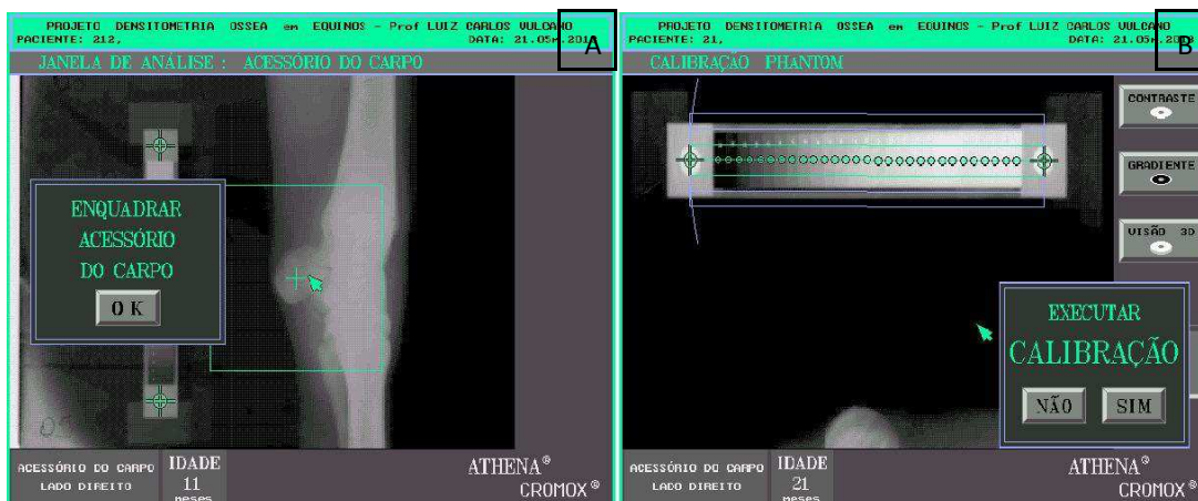
FIGURA 08. Imagem A - Momento em que acontece o enquadramento do osso acessório do carpo; Imagem B - Momento em que ocorre a calibração da escala de alumínio para a posterior comparação com o osso acessório já calibrado.
