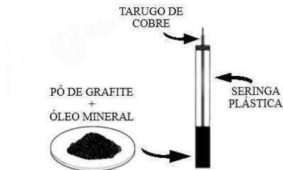
Figura 8- Esquema ilustrativo de montagem do EPC
