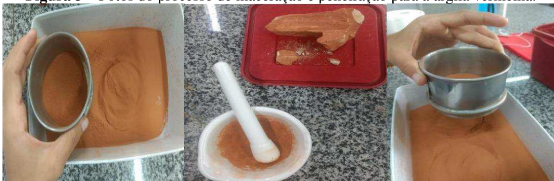
Figura 3 – Fotos do processo de maceração e peneiração para a argila vermelha.
