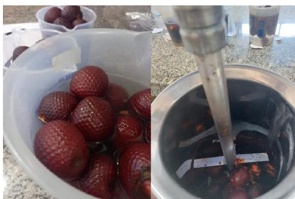
Figura 5: Frutos de buriti submergidos em água (esquerda); Frutos de buriti na despulpadora vertical (direita).
