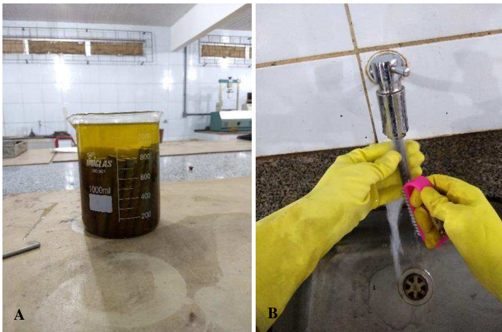
Figura 3.1 – Processo de limpeza química da armadura: (A) imersão em solução de HCl, água destilada e C_6H_{12}N_4 ; (B) lavagem em água corrente com escova de cerdas plásticas.
