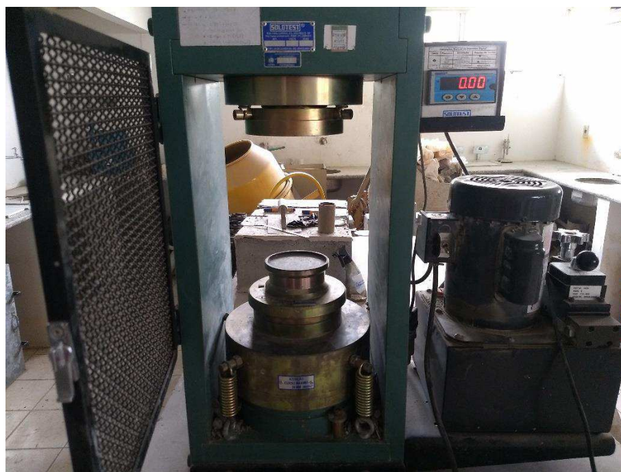
Figura 3.9 – Prensa eletrohidráulica para rompimento dos corpos de prova cilíndricos.
