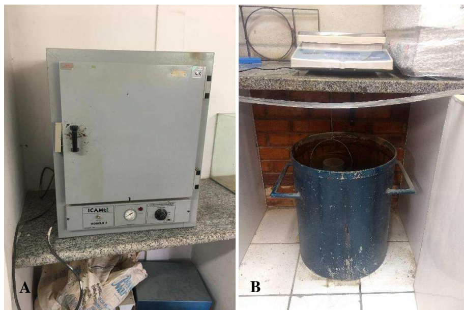
Figura 3.10 – Equipamentos utilizados para determinação do índice de vazios: (A) estufa para esterilização e secagem; (B) balança hidrostática.
