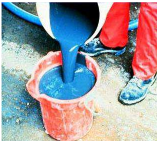
Figura 2.5 – Sílica ativa em suspensão aquosa
