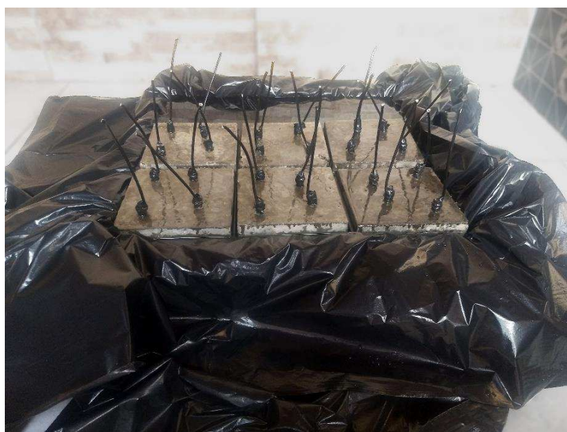
Figura 3.13 – Corpos de prova prismáticos imersos em solução de 5% de NaCl.
