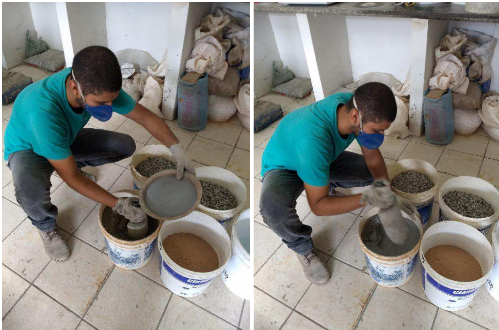
Figura 3.6 – Homogeneização prévia da sílica ativa com o cimento.
