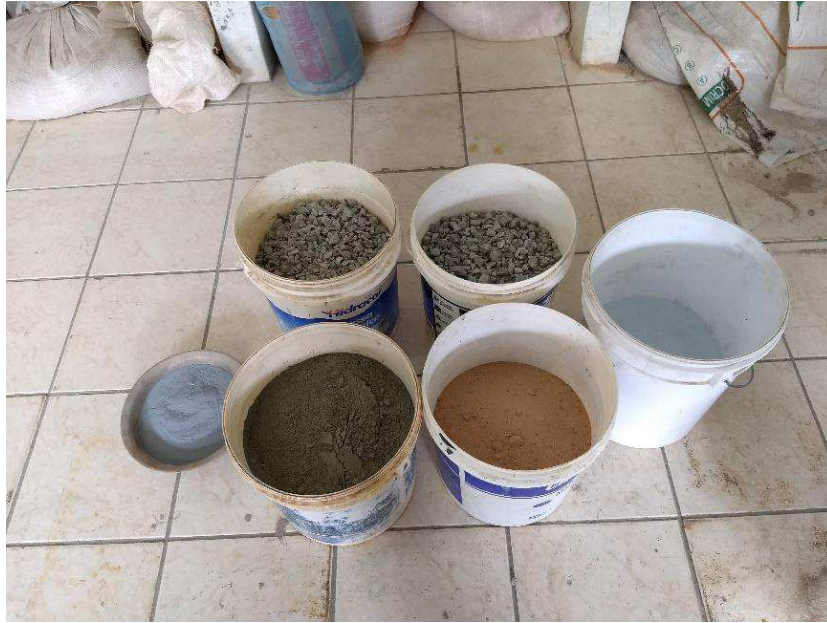
Figura 3.5 – Materiais separados em recipientes após a pesagem.
