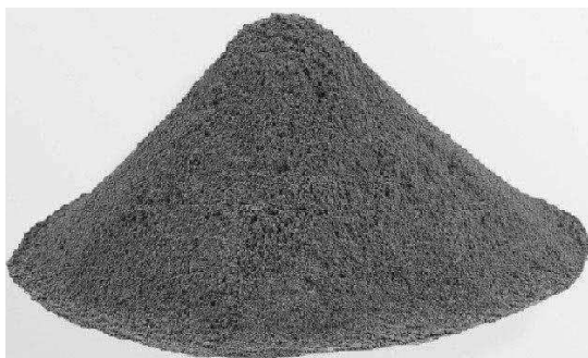
Figura 2.3 – Sílica ativa não densificada
