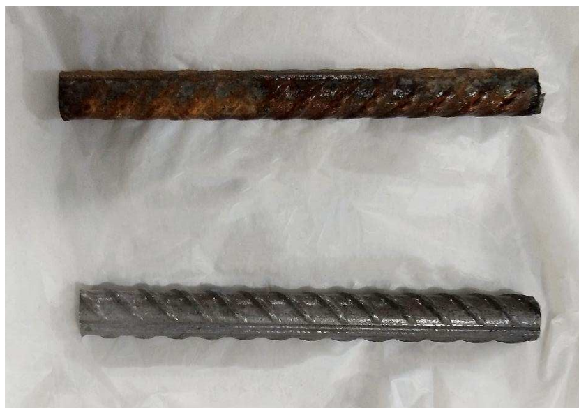
Figura 3.2 – Comparação visual entre as barras antes (superior) e após (inferior) das etapas de limpeza química/mecânica.
