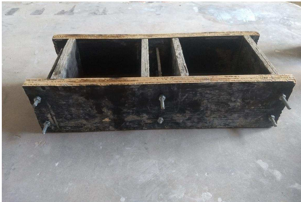
Figura 3.4 – Molde de madeirite plastificado para confecção dos corpos de prova prismáticos.
