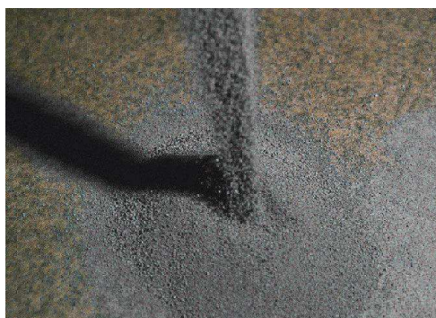
Figura 2.4 – Sílica ativa densificada
