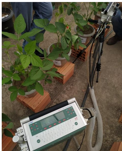
Figura 6. Sistema portátil de medições de trocas gasosas, IRGA modelo LI-6400XT (LI-COR, Lincoln, NE, USA).
