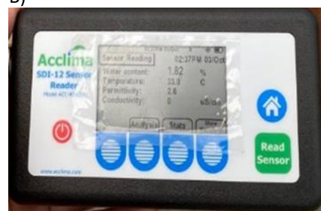
Figura 3. Metodologia de manejo da irrigação (A) e sensor de umidade modelo TDR-315H, Acclima, Idaho, USA, que foi utilizado para determinar a umidade do solo durante o manejo da irrigação e a imposição das condições de déficit hídrico (B). PSS = Peso de solo seco; LSS = Leitura de solo seco; PSU = Peso de solo úmido; LSU = Leitura de solo úmido.
