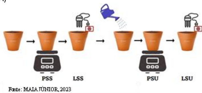
Figura 3. Metodologia de manejo da irrigação (A) e sensor de umidade modelo TDR-315H, Acclima, Idaho, USA, que foi utilizado para determinar a umidade do solo durante o manejo da irrigação e a imposição das condições de déficit hídrico (B). PSS = Peso de solo seco; LSS = Leitura de solo seco; PSU = Peso de solo úmido; LSU = Leitura de solo úmido.
