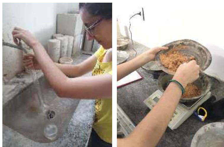
Figura 22 - Ensaio de massa específica. (a) Preenchimento do Frasco Chapman (b) Pesagem do material.
