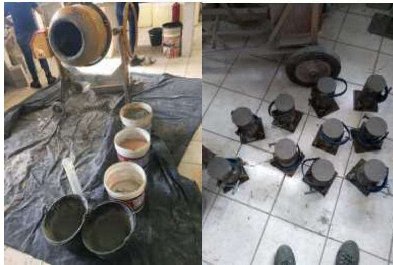
Figura 36 - Moldagem dos corpos-de-prova. (a) Separação do traço. (b) Corpos-de-prova após moldagem.
