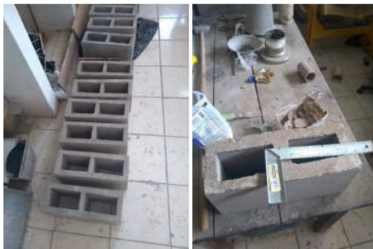
Figura 41 - Análise Dimensional. (a) Blocos armazenados. (b) Régua de aço.
