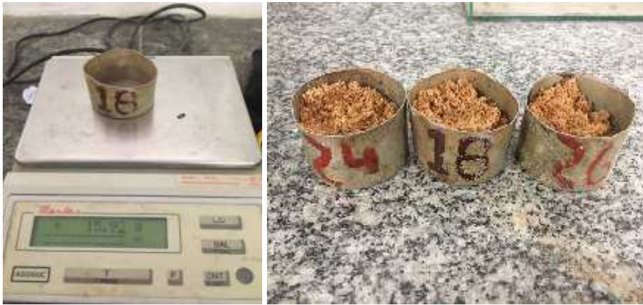
Figura 25 - Procedimento da umidade da areia. (a) Pesagem da cápsula (b) Pesagem do conjunto cápsula-agregado úmido.
