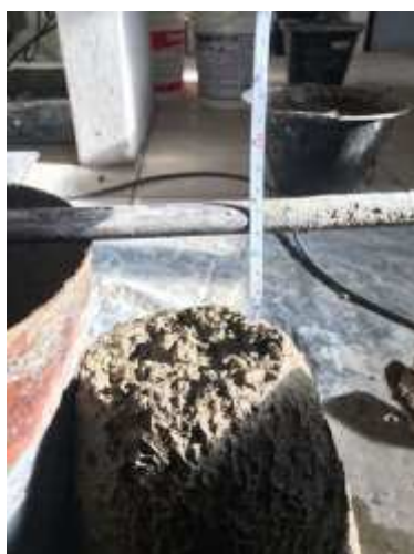
Figura 37 - Abatimento sendo medido.
