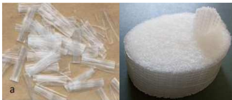
Figura 5 - Tipos de fibras poliméricas. (a) fibras fibriladas, (b) macrofibras.
