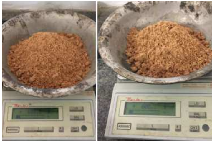
Figura 21 - Pesagem do material úmido. (a) Amostra 1 (b) Amostra 2.
