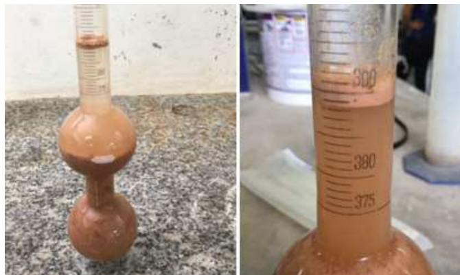
Figura 23 - Ensaio de massa específica em andamento. (a) Frasco Chapman preenchido com água e agregado. (b) Detalhe da variação de volume.
