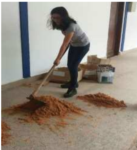
Figura 24 - Processo de quarteamento em andamento.
