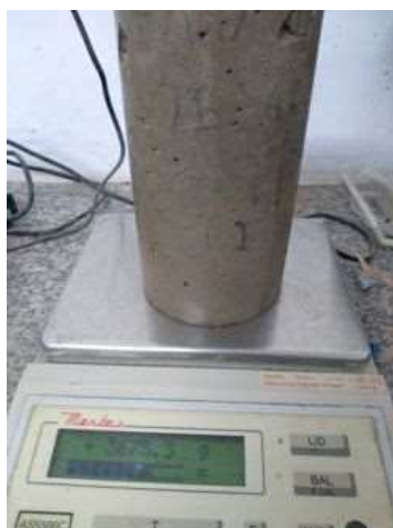
Figura 38 - Pesagem do corpo-de-prova saturado.
