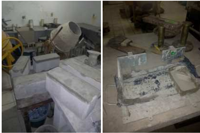
Figura 42 - Processo de capeamento. (a) Blocos após o capeamento. (b) Base metálica utilizada para o capeamento.
