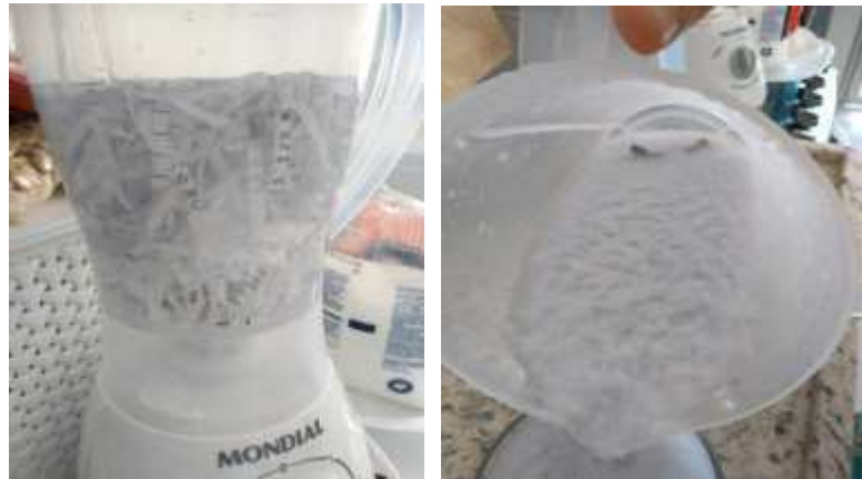
Figura 34 - Tratamento do papel. (a) Trituração das tiras de papel. (b) Consistência após a trituração.
