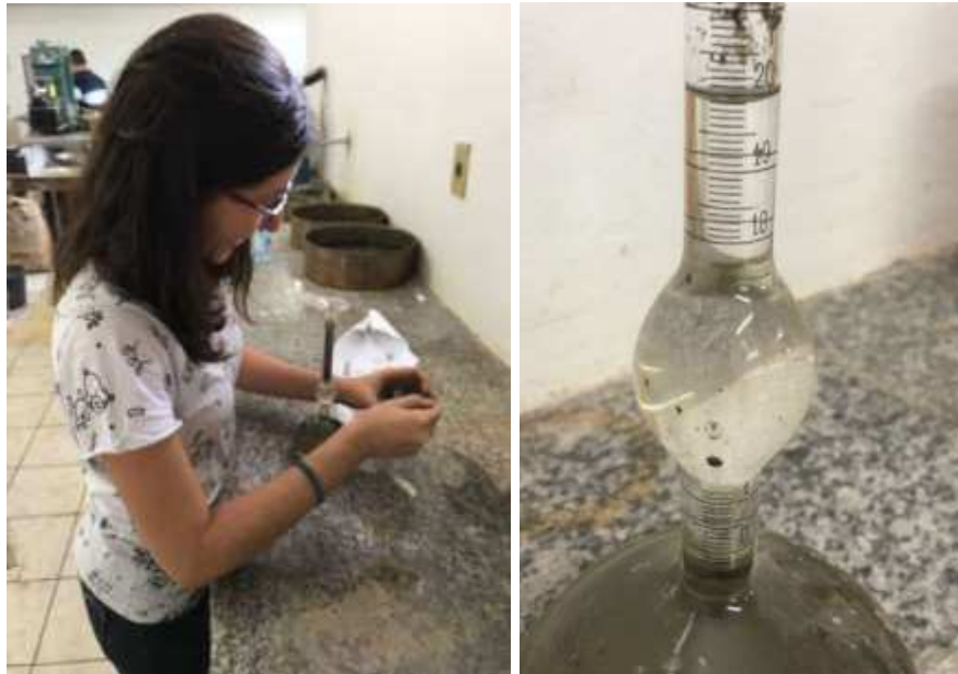
Figura 32 - Ensaio de massa específica. (a) Pesagem do aglomerante. (b) Leitura final.
