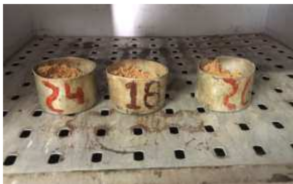
Figura 26 - Cápsulas do ensaio durante o processo de secagem na estufa.
