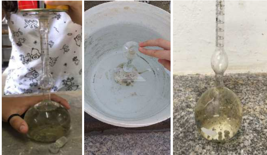
Figura 31 - Ensaio de massa específica. (a) Preenchimento do frasco Le Chatelier (b) Submersão em banho termorregulador. (c) Primeira leitura.
