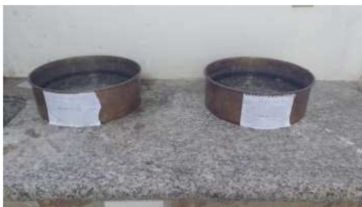
Figura 28 - Amostras em imersão de água para saturação.
