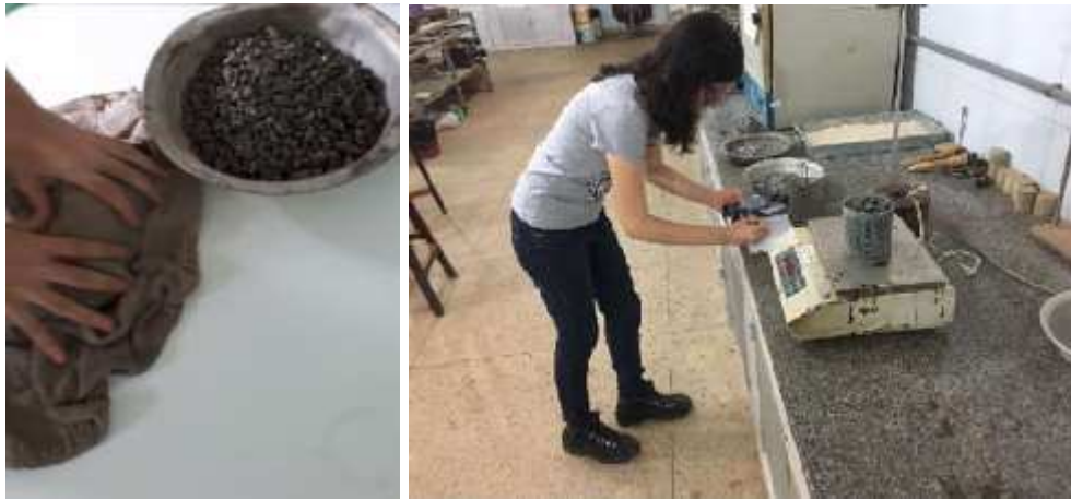
Figura 29 - Procedimento de ensaio (a) Secagem da brita (b) Pesagem da brita saturada seca superficialmente.
