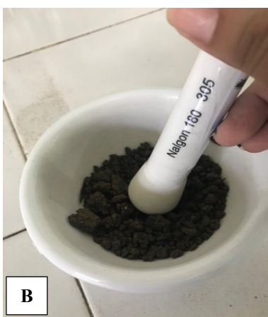
Figura 6 - Preparo das amostras. A. Material preparado para estufa; B. Maceração do material; C. Peneiramento do material.
