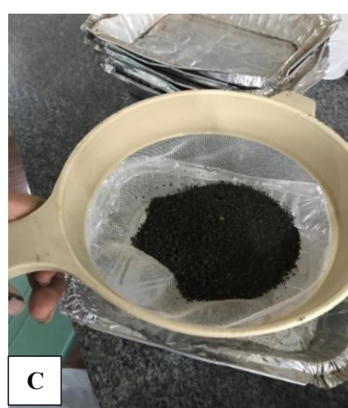
Figura 6 - Preparo das amostras. A. Material preparado para estufa; B. Maceração do material; C. Peneiramento do material.
