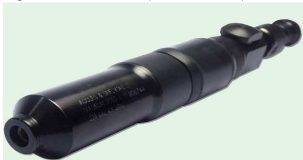
Figura 7 – Dardo cativo penetrante do tipo “bastão”
