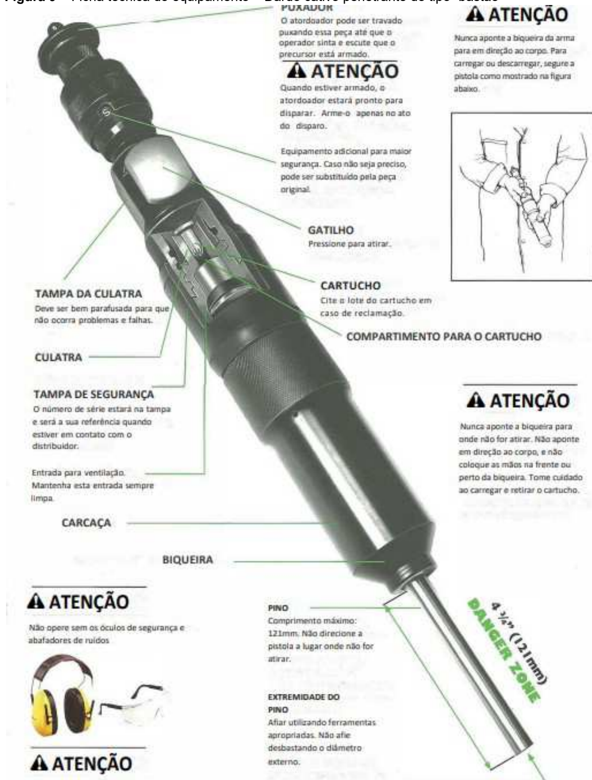
Figura 9 – Ficha técnica do equipamento – Dardo cativo penetrante do tipo “bastão”
