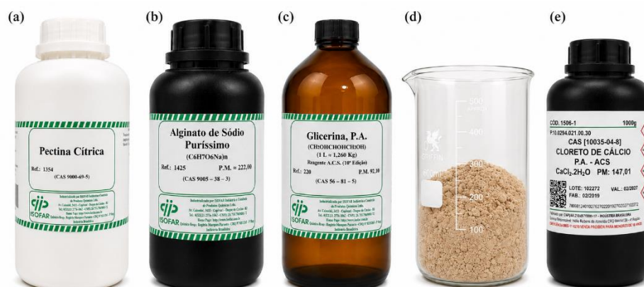
Figura 1 - Materiais utilizados na preparação dos biofilmes: (a) pectina cítrica; (b) alginato de sódio; (c) glicerina; (d) amido do mesocarpo do coco babaçu; e (e) cloreto de cálcio.
