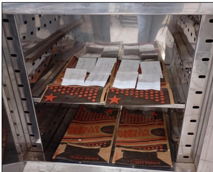
Figura 9. Processo de secagem de massa fresca acondicionada em estufa.
