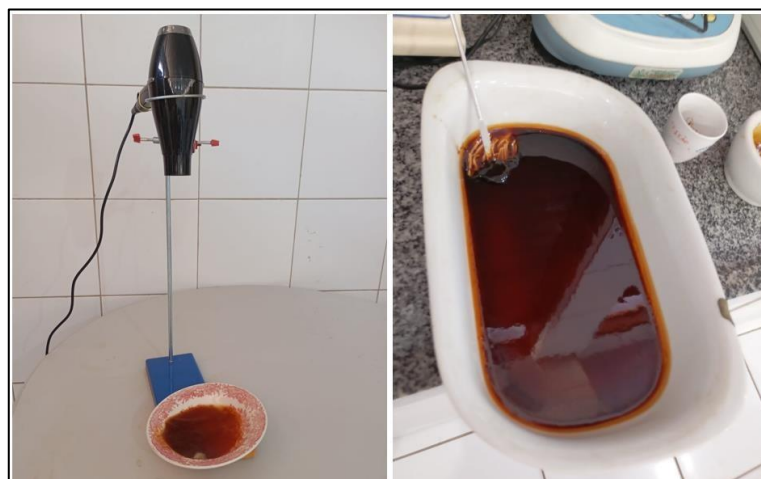
Figura 5. Processo de evaporação da água destilada e obtenção do extrato de feijão-guandu.
