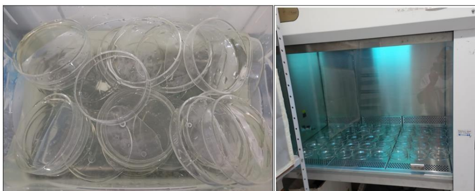
Figura 6. Placas de petri em solução de hipoclorito e em câmara de fluxo laminar.
