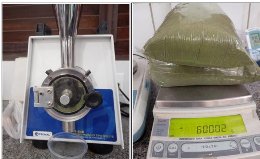
Figura 3. Trituração e pesagem do material vegetal.
