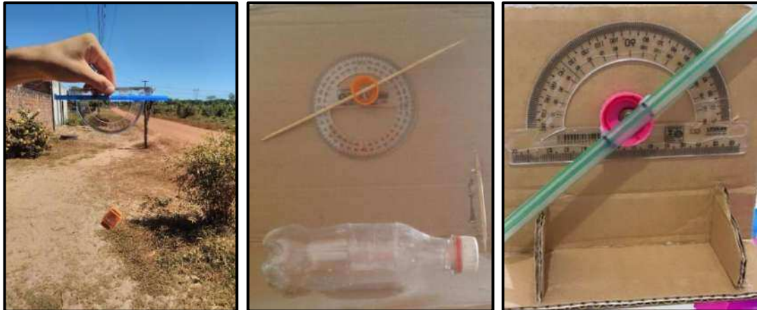
Figura 17 – Teodolitos caseiros construídos pelos grupos
