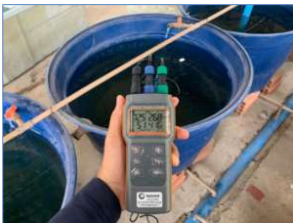
Figura 9 – Análise dos parâmetros físico-químicos da água utilizando um multiparâmetro digital
