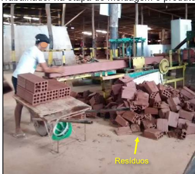
Figura 40 - Trabalhador na etapa de moldagem e produtos defeituosos
