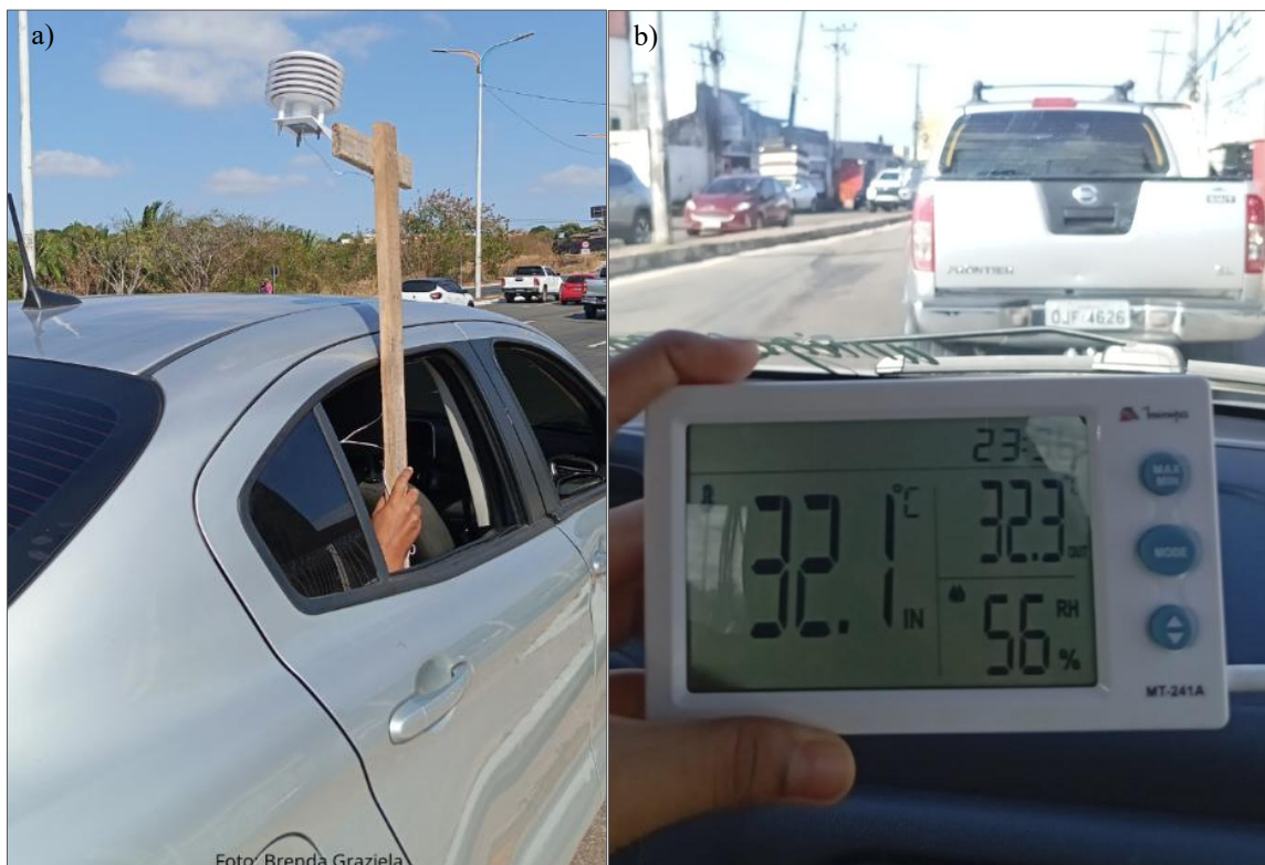
Figura 8 - a) Abrigo do termo-higrômetro; b) Registro das medições por transecto móvel (18/10/2024)
