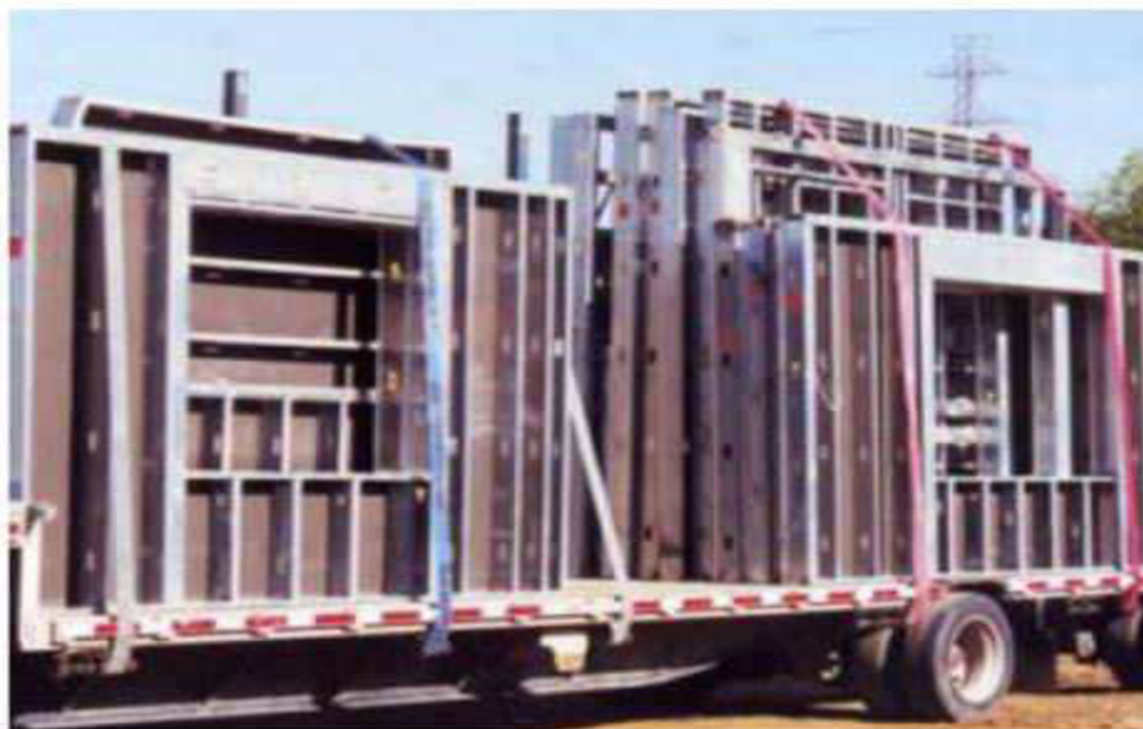
Figura 10- Transporte de painéis prontos para a obra
