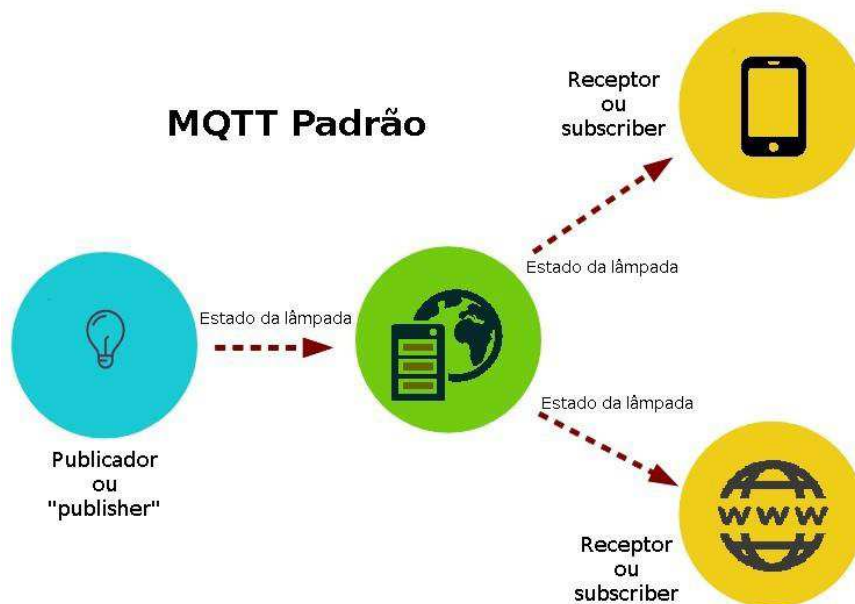
Figura 7 - Exemplo da arquitetura do MQTT.
