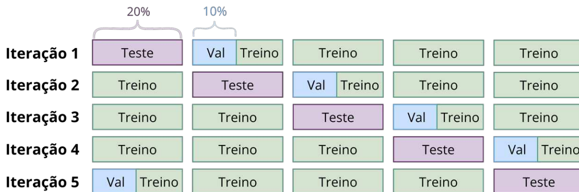
Figura 12 – Visualização da validação cruzada e da divisão dos dados. Teste , Val e Treino representam os conjuntos de testes, de validação e de treinamento, respectivamente. Um retângulo representa 20% de todos os dados.
