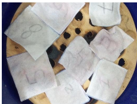
Figura 9 – Saquinhos contendo as amostras, dispostos no dessecador após a autoclavagem e secagem em estufa a 105°C para determinação de FDN/FDA.
