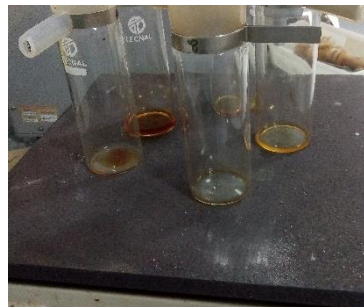
Figura 8 – Copos de extração contendo o resíduo lipídico, dispostos na chapa aquecedora para a evaporação do éter de petróleo.
