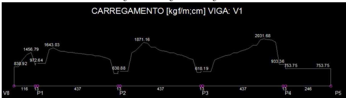
Figura 38 - Carregamento da viga V1
