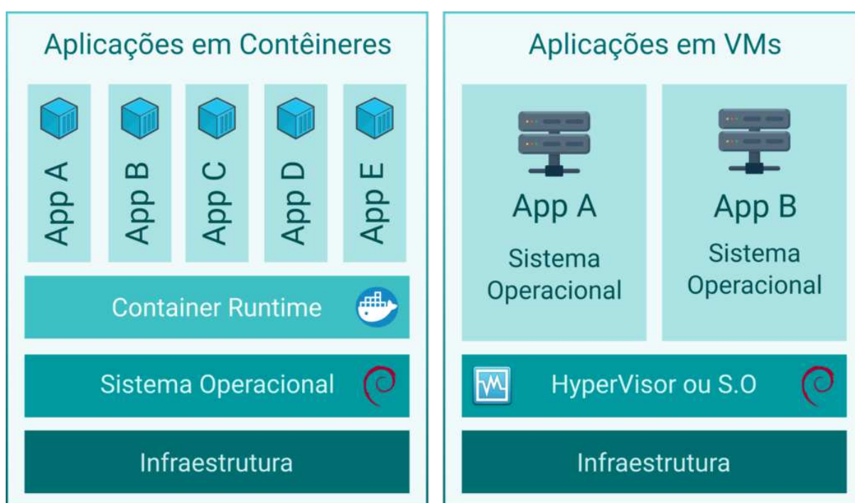
Figura 6 – Comparativo arquitetônico entre Máquinas Virtuais e Contêineres
