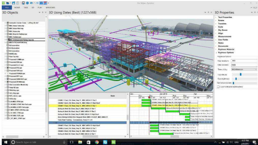
Figura 3 –Software demonstrativo do gerenciamento de projetos e obra – SYNCHRO (4D).
