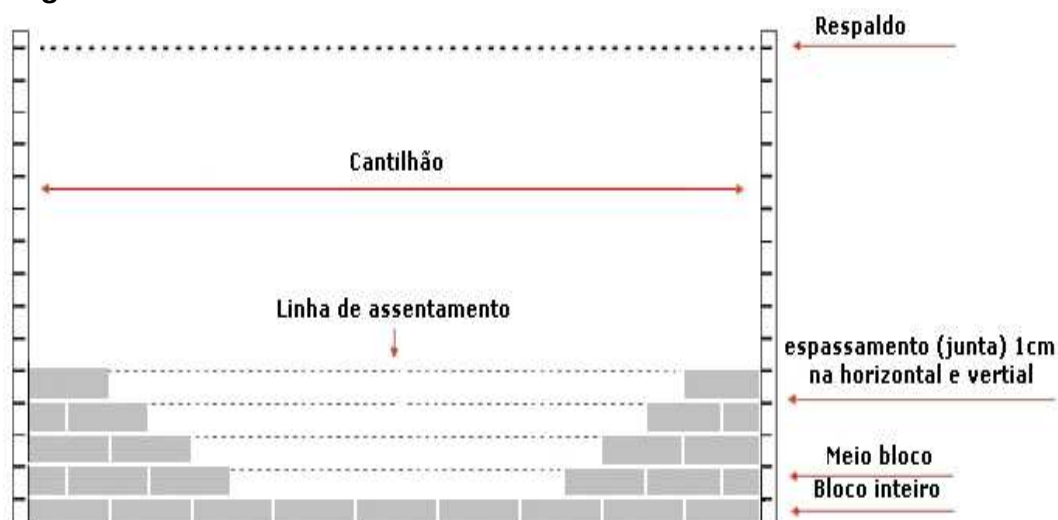
Figura 10 – Uso do escantilhão e linha no assentamento da alvenaria cerâmica.
